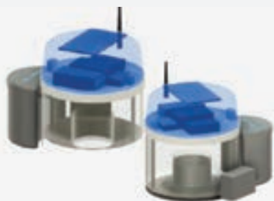
Παγίδα τεχνητής νοημοσύνης με ενσωματωμένο φωτογραφικό φακό
