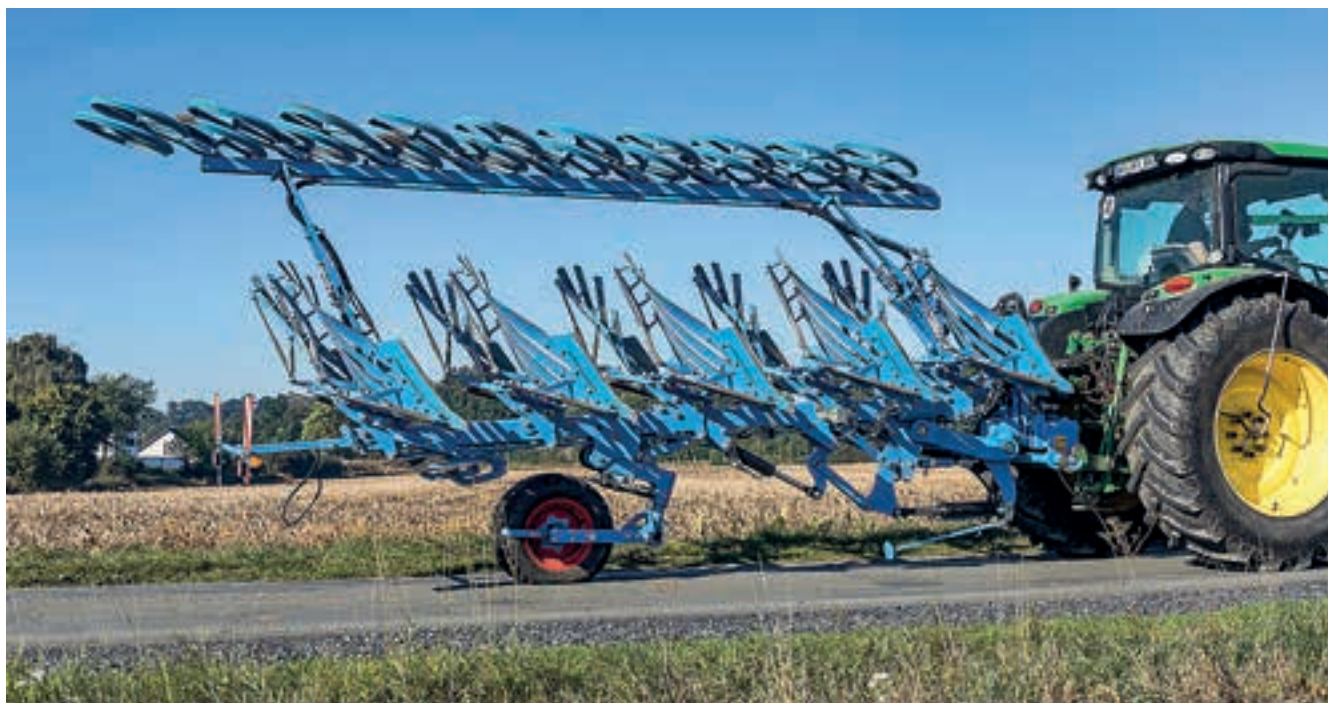
Ο τροχός βάθους πρέπει να αντικατασταθεί για κίνηση στο δρόμο. Οι ρυθμίσεις μεταφοράς μπορούν να επιλεγούν εύκολα στο τερματικό.
