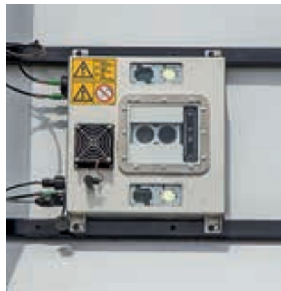
Κάθε μονάδα κάμερας του μηχανήματος διαθέτει κάμερα RGB, φλας και υπέρυθρο αισθητήρα.
