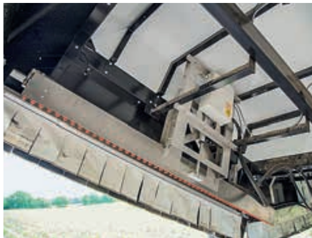
Η θέση της ράβδου ακροφυσίων ρυθμίζεται ηλεκτρονικά, ανάλογα με το ύψος της καλλιέργειας. Αυτό αυξάνει την ευελιξία.
