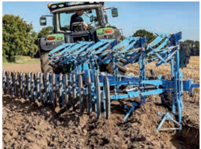
Το FlexPack μπορεί να ανασκωθεί εκτός εργασίας. Τα ηλεκτρονικά συστήματα καθιστούν δυνατή τη γρήγορη αλλαγή των ρυθμίσεων.
