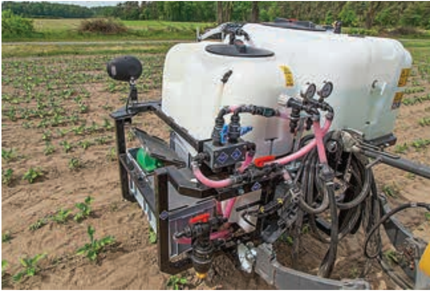
Στα δεξιά, υπάρχει η δεξαμενή καθαρού νερού με χωρητικότητα 500 λίτρα. Στα αριστερά, υπάρχει η δεξαμενή χωρητικότητας 200 λίτρων για το υγρό ψεκασμού.
