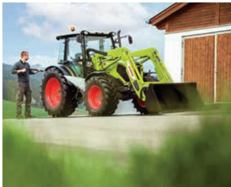
Τα AXOS φέρουν ισχύ 92 και 103 ίππων, κιβώτιο ταχυτήτων 5 ταχυτήτων με μηχανισμό αλλαγής ταχυτήτων REVERSHIFT και TWINSHIFT, μεγέθη τροχών έως 34 ίντσες, μικτό βάρος 6 τόνους.
