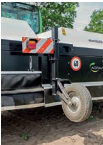
Όλοι οι τροχοί υποστήριξης ρυθμίζονται σύμφωνα με το τρέχον πλάτος ίχνους και το ύψος της καλλιέργειας.
