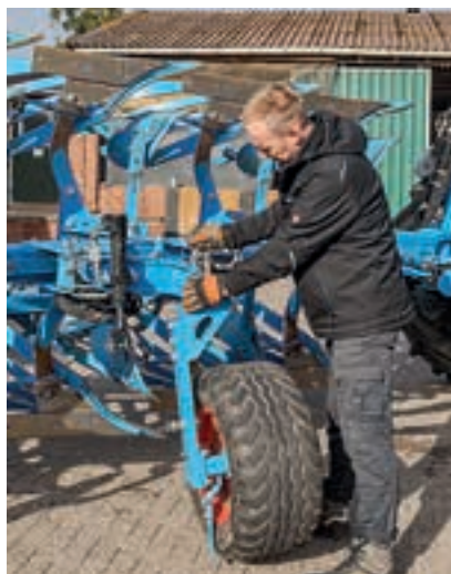
Ο τροχός βάθους πρέπει να αντικατασταθεί για κίνηση στο δρόμο. Οι ρυθμίσεις μεταφοράς μπορούν να επιλεγούν εύκολα στο τερματικό.
