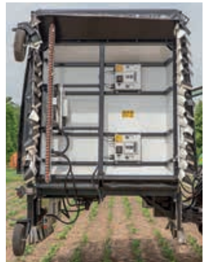
Δυο μονάδες κάμερας βρίσκονται κάτω από κάθε βάση ψεκασμού, που περιλαμβάνει μπούμα ψεκασμού.
