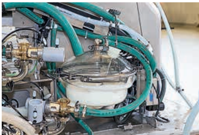
Για να διασφαλιστεί ότι όλοι οι αισθητήρες λειτουργούν σωστά, η DLG πραγματοποιεί πάντα τις δοκιμές ενώ υπάρχει γάλα στο σύστημα.
