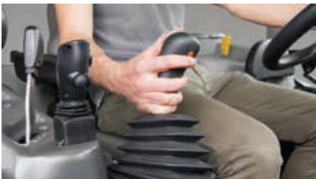
Το κουμπί συμπλέκτη στο πίσω μέρος του μοχλού αλλαγής ταχυτήτων των Axos εξαλείφει τη χρήση του ποδοσυμπλέκτη.
