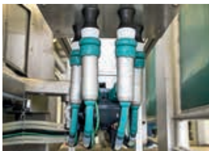
Δεν απαιτούνται βούρτσες εδώ – το σύστημα Gea καθαρίζει τις θηλές μέσα στις θήκες.
