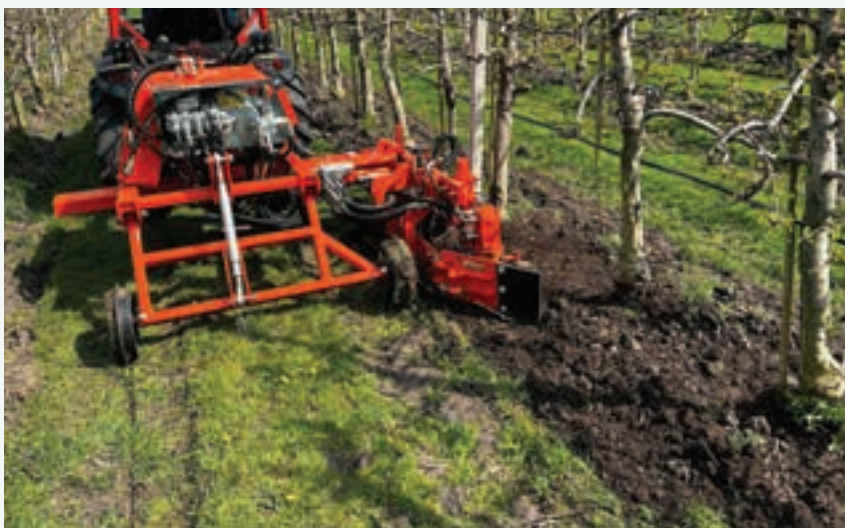
Το Turbo EVO Μπορεί να δεχθεί τις εξής κεφαλές: Λάμα, άροτρο, δισκοσβάρνα, μεσινέζα, καταστροφέα, χορτοκοπτικό, σβολοκόπη. Επίσης προσφέρει αυτόματη ρύθμιση για άνοιγμα-κλείσιμο.
