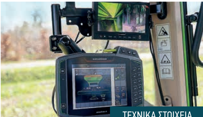
Ο διανομέας ZG-TX λειτουργεί μέσω της οθόνης που είναι συμβατή με ISObus.
