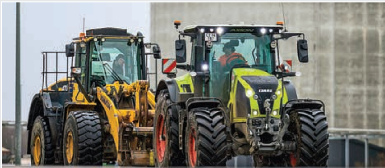
Ένας τροχοφόρος φορτωτής 25 τόνων για τις μετρήσεις ισχύος της ράβδου έλξης.
