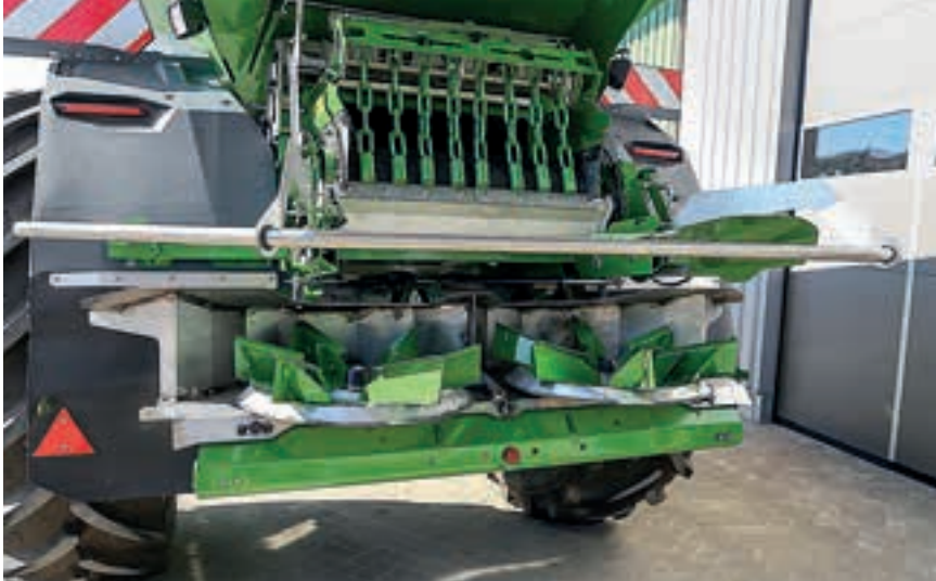
Το σύστημα διανομής ασβέστη, που περιλαμβάνει εκτροπέα για το κεφαλάρι δεξιά.
