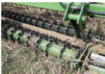
Η διπλή μονάδα στη μέση μπορεί επίσης να φιλοξενήσει δίσκους σε σχήμα αστεριού ή κυματιστούς, ακόμη και κυλίνδρους μαχαιριών.
