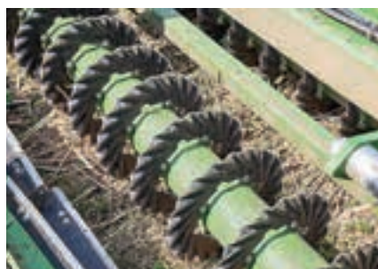
Η διπλή μονάδα στη μέση μπορεί επίσης να φιλοξενήσει δίσκους σε σχήμα αστεριού ή κυματιστούς, ακόμη και κυλίνδρους μαχαιριών.
