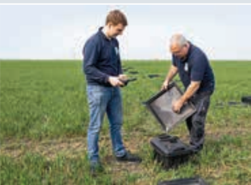
Οι κόκκοι που συλλέχθηκαν στις θήκες συσσωρεύθηκαν κατά σειρά, ζυγίστηκαν και τα αποτελέσματα αξιολογήθηκαν άμεσα.
