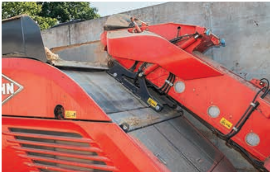
Ο βραχίονας φρεζαρίσματος μπορεί να ολισθαίνει στο πλάι, έτσι ώστε το Aura να επανατοποθετείται μόνο όταν έχει κόψει μια λωρίδα πλάτους 1,50μ.
