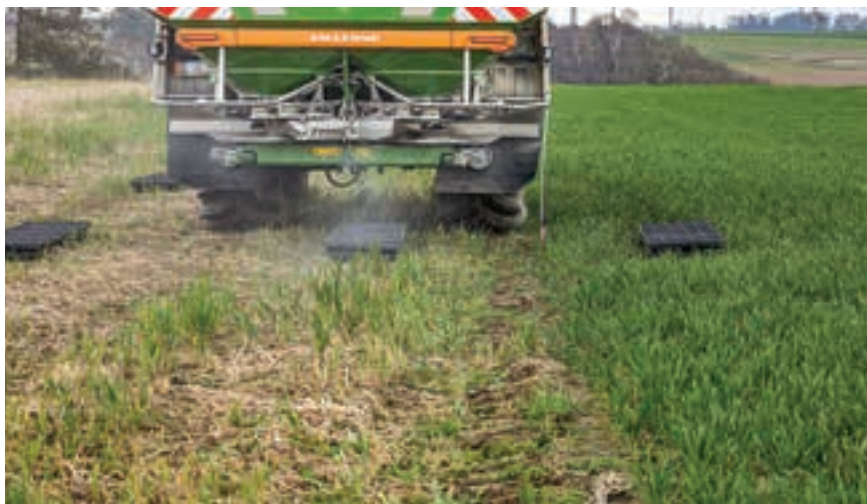
Ο κεντρικός εκτροπέας BorderTS αποτρέπει τη διασπορά λιπάσματος από τον αριστερό δίσκο να ξεπεράσει τα σύνορα του χωραφιού. Ο δεξιός δίσκος απενεργοποιείται κατά τη διανομή μέσω του Border TS.
