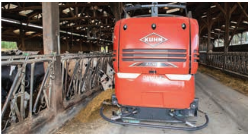
Ο εγκάρσιος μεταφορέας πλάτους 40 εκατοστών μπορεί να διανέμει το μείγμα και από τις δύο πλευρές. Δύο βούρτσες κατευθύνουν την τροφή προς τον φράχτη τροφοδοσίας.
