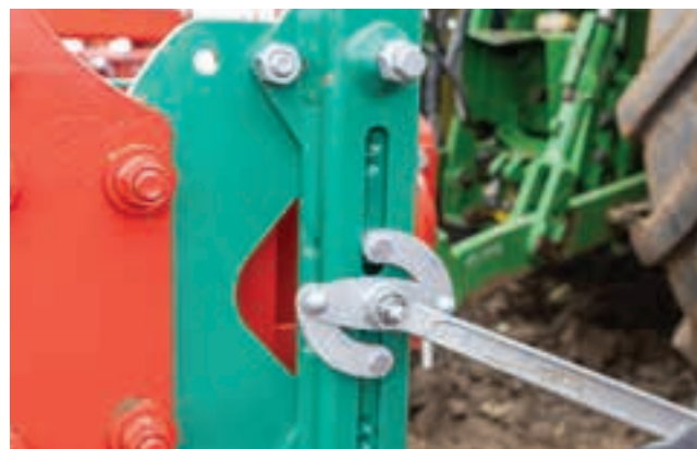
Η κεντρική προσαρμογή των skimmer μετακινεί ταυτόχρονα πάνω και κάτω διαχωριστές, με πειρούς κλειδώματος να βελτιώνουν ακρίβεια και ασφάλεια.
