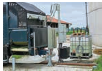
Στο χώρο στάθμευσης, το Exos επαναφορτίζει την μπαταρία και γεμίζει με υγρό λίπασμα.
