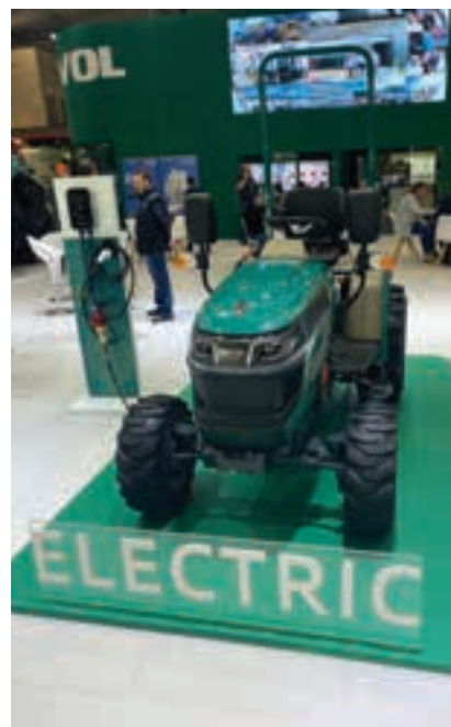
Η Lovol παρουσίασε τα 25hp, E1000 πλήρως ηλεκτρικά πρωτότυπα. Αναμένεται να είναι διαθέσιμα μέχρι την επόμενη Agritechnica το 2027. Με μπαταρία ιόντων λιθίου 27kWh μπορεί να δουλέψει συνεχόμενα για 6 ώρες.
