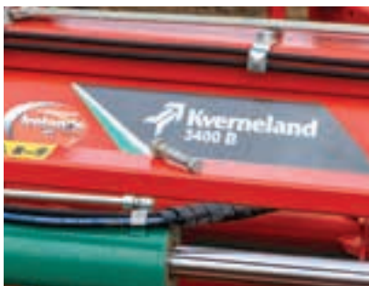
Η νέα σχεδίαση των μπουλονιών περιλαμβάνει ρηχές αυλακώσεις που ταιριάζουν με τις πλάκες στήριξης ποδιού, επιτρέποντας καθαρό σπάσιμο.
