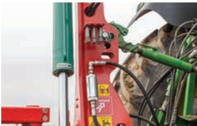
Η κεφαλή μεταφέρει φίλτρο υδραυλικού λαδιού τύπου φυσιγγίων και έχει αποθηκευτικό χώρο για έως εννιά ανταλλακτικά μπουλόνια διάτμησης.
