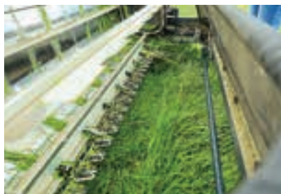
Οι λεπίδες στην μπάρα κοπής πλάτους 2.0μ. πρέπει να ακονίζονται εβδομαδιαία για βέλτιστη απόδοση.
