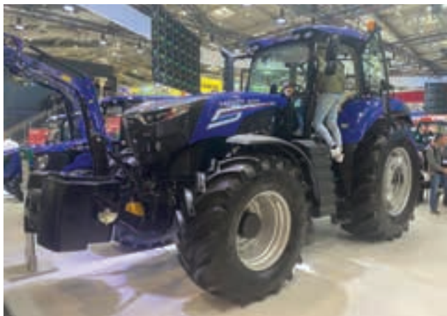
Η μέγιστη ταχύτητα του 18μπ.+9πίσω power shuttle του 10,8τ. TN3004 είναι 40χλμ/ώ. Ο πίσω σύνδεσμος σπκώνει ως και 8,5τ.
