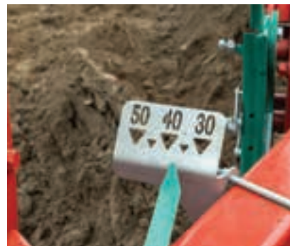
Η πλάκα plasma-cut προσφέρει διάγνωση και μακροζωία για μαρκάρισμα του πλάτους σειράς.
