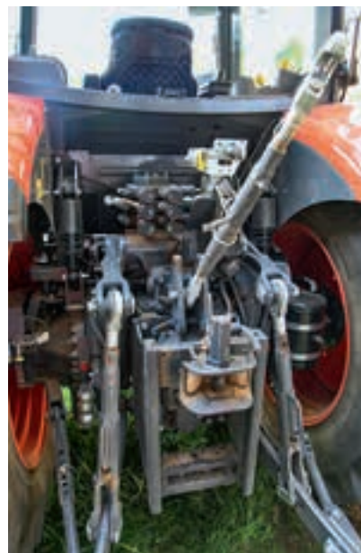
Ανάρτηση καμπίνας, με ανίχνευση φορτίου τα υδραυλικά των 115 λίτρων / λεπτό και πίσω ανύψωση 7.000 κιλών.
