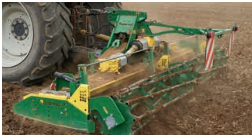
Η περιστροφική σβάρνα Moreni πλάτους 5 μ. χρησιμοποιείται κυρίως μετά τις καλλιέργειες χορτονομής.
