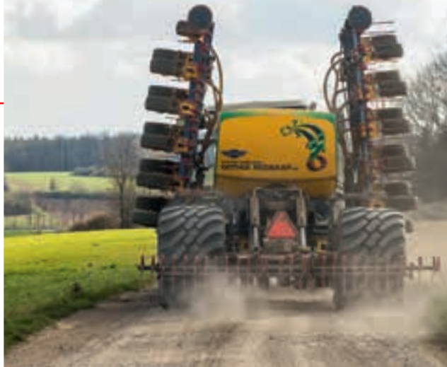
Προκειμένου να επιτευχθεί πλάτος για κίνηση στο δρόμο στα 3,18 μέτρα, οι μονάδες πρέπει να τραβιούνται μία μία με μη αυτόματο τρόπο.
