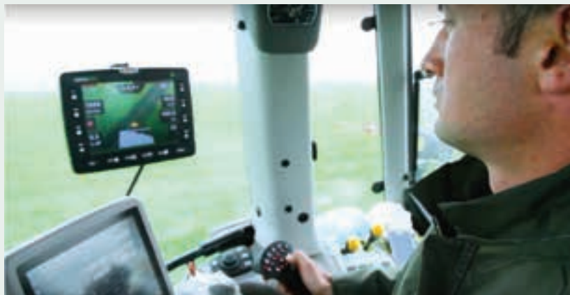
Ο χειρισμός του ψεκαστικού και της βέργας γίνεται με τον υπολογιστή DELTA 80 με οθόνη 8,4" και ένα εργονομικό Joystick.
