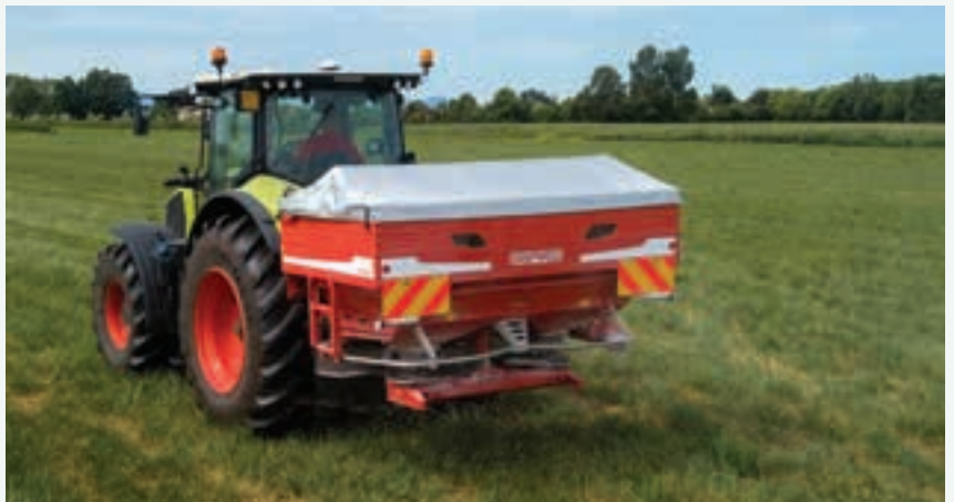
Αυτό που κάνει τον λιπασματοδιανομέα Gaspardo Primo EW να ξεχωρίζει είναι ο αυτόματος τμηματικός έλεγχος (section control) που επιτυγχάνεται μέσω GPS σε χαρτογραφημένο χωράφι.
