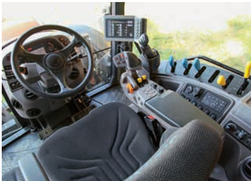
Τα χειριστήρια του υποβραχιονίου φροντίζουν το κιβώτιο ταχυτήτων και τον σύνδεσμο. Τα μηχανικά καρούλια και ο μπροστινός μοχλός φορτωτή βρίσκονται στην πλαϊνή κονσόλα. Οι μοχλοί των καρουλιών δεν έχουν χρωματική κωδικοποίηση και, όπως και σε άλλα μέρη του εσωτερικού, δε φαίνονται τόσο ποιοτικά.
