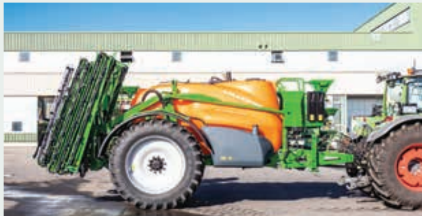
Η ράμπα ψεκασμού διαθέτει ανάρτηση σε σχήμα παραλληλόγραμμου και πολλαπλή απόσβεση κραδασμών.
