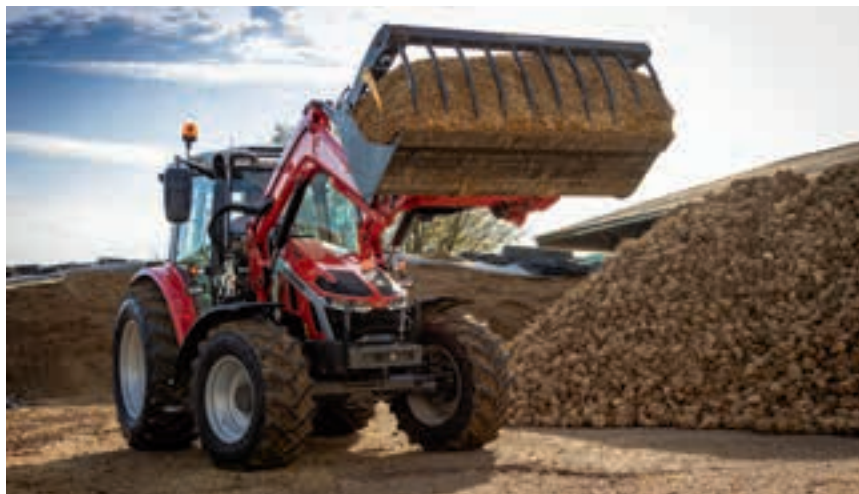
Η MF ολοκλήρωσε έναν γύρο ανανεώσεων τρακτέρ με την εισαγωγή της σειράς 5S υψηλών προδιαγραφών με τετρακύλινδρους κινητήρες AGCO Power Stage V, τρία επίπεδα εξοπλισμού και επιλογές γεωργίας ακριβείας.
