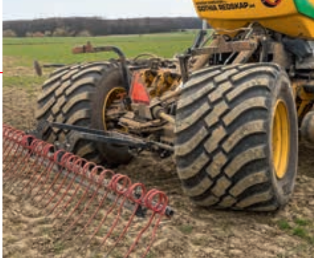
Χάρη στον διευθυντήριο άξονα, το μηχάνημα κινείται στα ίδια ίχνη τροχών με το τρακτέρ... στην καλλιέργεια, στο κεφαλάρι και στις στροφές.
