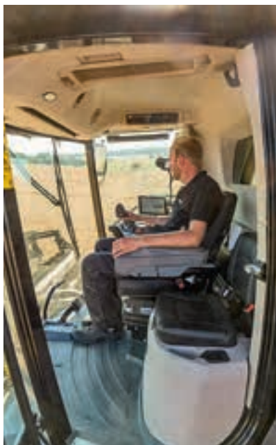
Πού βρίσκεται το τιμόνι και η κολόνα του; Τη θέση αυτών παίρνει τώρα το νέο joystick.
