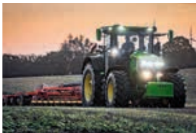
Η John Deere μεγάλωσε τη σειρά 7R με το 388 ίππων 7R 350 με στάνταρ κιβώτιο AutoPowr και αναλογία ισχύος προς βάρος 29 κιλά ανά ίππο.
