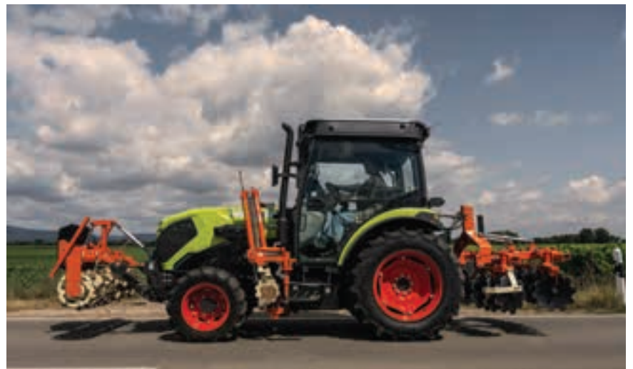
Το μικρό πλάτος μόλις 1-1,55 μέτρων επιτρέπει στα τέσσερα μοντέλα της καινούργιας σειράς να κινούνται με άνεση μεταξύ των σειρών των αμπελώνων και στους οπωρώνες
