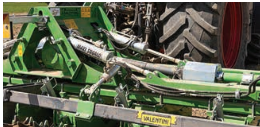
Κάθε φτερό διπλώνει μέσω δύο υδραυλικών εμβόλων.
