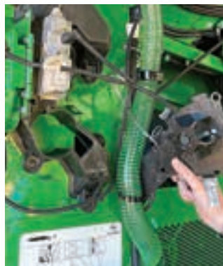
Ο κοχλίας ξεφορτώματος 150λιτ/δευτ. και το περιστρεφόμενο στόμιο είναι κοινά με το Χ9.
