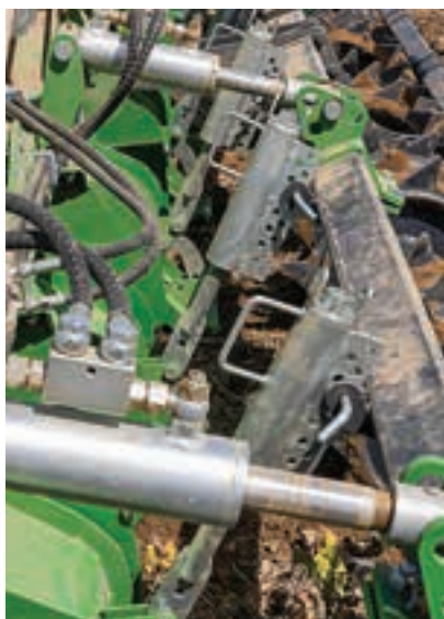
Ο κύλινδρος, που φροντίζει για τον έλεγχο βάθους, ρυθμίζεται υδραυλικά.
