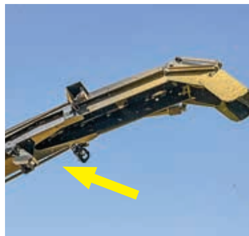
Ο νέος αισθητήρας ραντάρ «CropSpeed» μετρά τη ροή καρπών στον αγωγό.
