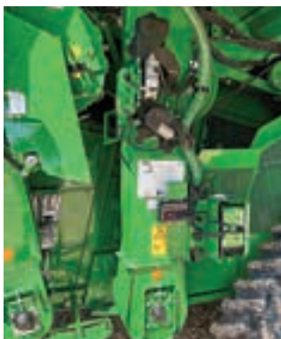
Ο κοχλίας ξεφορτώματος 150λιτ/δευτ. και το περιστρεφόμενο στόμιο είναι κοινά με το Χ9.
