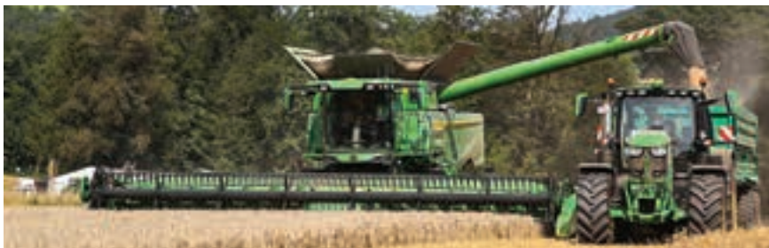
Ο κοχλίας ξεφορτώματος 150λιτ/δευτ. και το περιστρεφόμενο στόμιο είναι κοινά με το Χ9.
