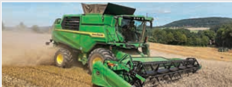
Τα μοντέλα με άλογα έχουν ανασχεδιαστεί με νέα καμπίνα και κινητήρα 9,0 λίτρων.
