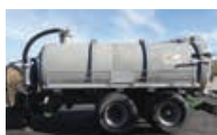
BYTIO ΛΥΜΑΤΩΝ VENDRAME
