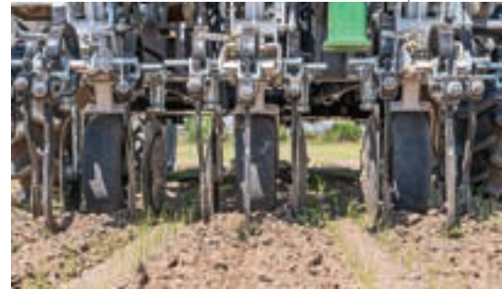
Το σκαπτικό DicksonKerner δουλεύει αρκετά κοντά στις σειρές των καλλιεργειών της οικογένειας.
