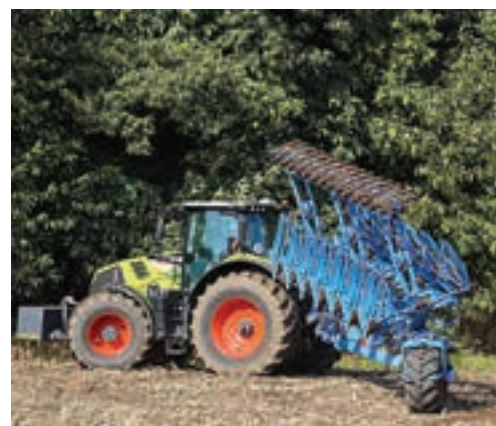
Ο τροχός μπορεί να στρίψει έως και 30°, εξοικονομώντας χώρο στο κεφαλάρι.
