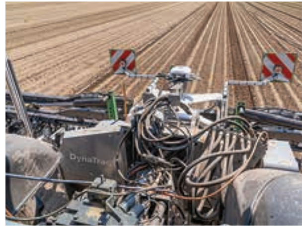
Η πλατφόρμα LaForge με πλοήγηση GPS διατηρεί το μηχανήμα σε τροχιά.
