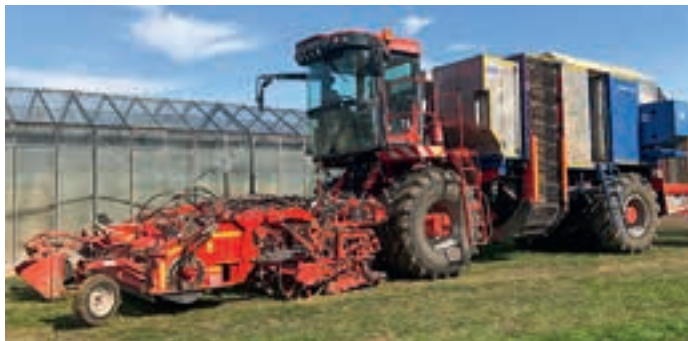
Η εταιρεία έχει μετατρέψει αυτή τη θεριστική μηχανή τεύλων Holmer Terra Dos T3 σε ένα κινητό εργαστήριο.
