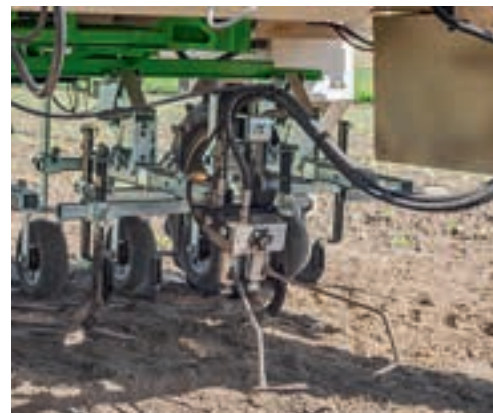
Το ηλεκτρο-υδραυλικό οδηγούμενο μαχαίρι της BlueBob μπορεί να δουλέψει στη σειρά.
