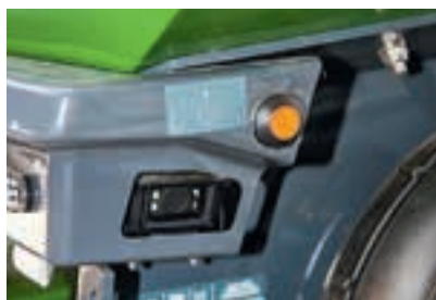
Μία από τις δύο πλευρικές κάμερες βρίσκεται κάτω από τη βαθμονόμηση, αριστερά από το μηχανήμα.
