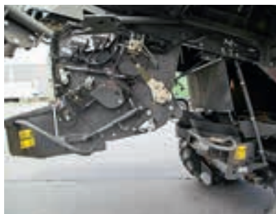
Ο διασκορπιστής άχυρου και ο τεμαχιστής έκαναν καλή δουλειά στη δοκιμή. Ωστόσο, οι διαμορφωτές θημωνιάς δεν μπορούν να διπλωθούν τελείως.
