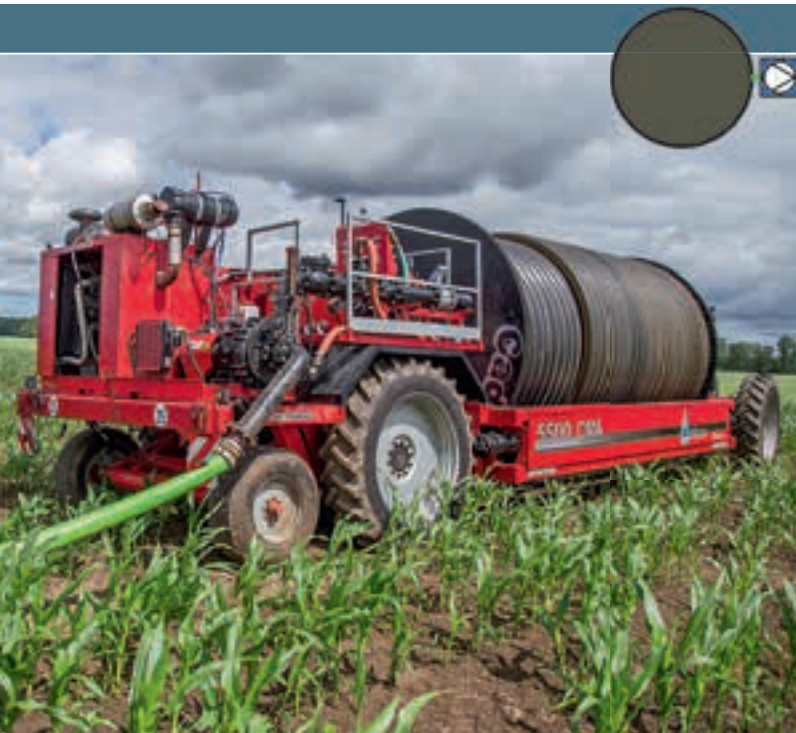
Η μονάδα καρουλιού Cadman, με την ενσωματωμένη αντλία και τον κινητήρα.
