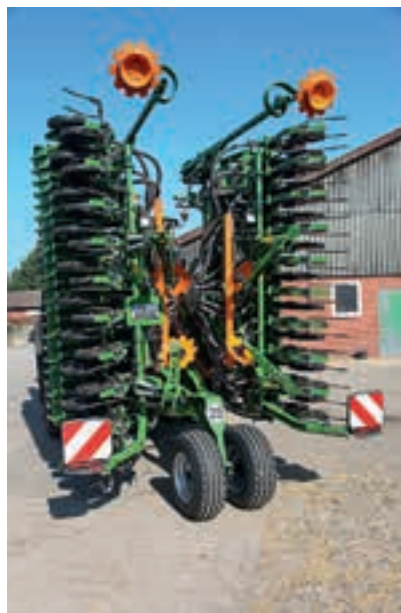
Με ελάχιστο βάρος πίσω 5,5 τόνους, οι προαιρετικοί τροχοί συνιστώνται.
