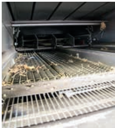
Το σύστημα καθαρισμού Jet Stream, με το διπλό αεριζόμενο σκαλοπάτι, βρίσκεται τώρα μπροστά.
