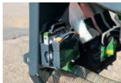
Το κιτ βαθμονόμησης παραμένει ανοικτό σε αυτό το βραχίονα κάτω από τον κάδο.
