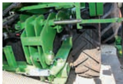
Για μεταφορά, ο συσκευαστής μπορεί να ανυψωθεί και να ασφαλιστεί στη θέση του.
