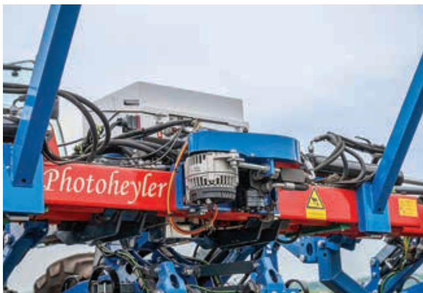
Ένας υδραυλικά κινούμενος δυναμώ παράγει ηλεκτρικό ρεύμα (48 volt) για την κίνηση των ρότορα.
