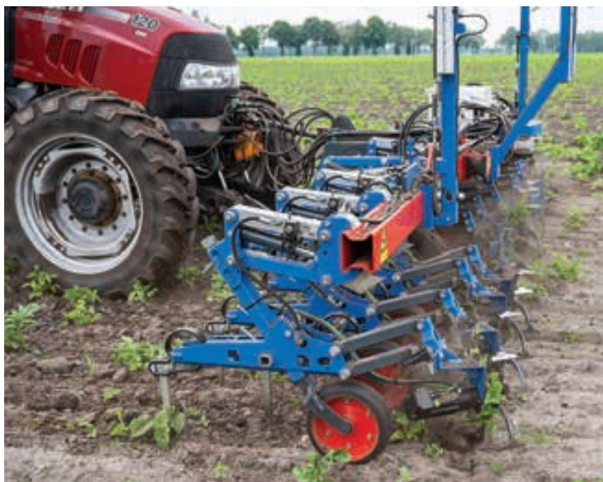
Ο άνω παραλληλόγραμμος σύνδεσμος περιλαμβάνει ενσωματωμένο μπλοκ βαλβίδων.
