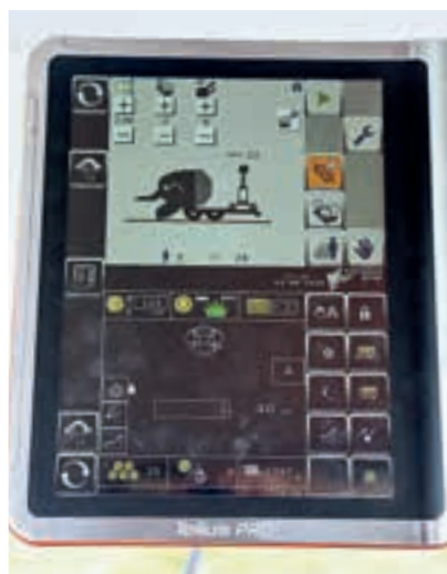
Δεν υπάρχει πλέον ανάγκη για δύο τερματικά. Αντ' αυτού, όλα γίνονται μέσω της οθόνης Tellus Pro ISObus.
