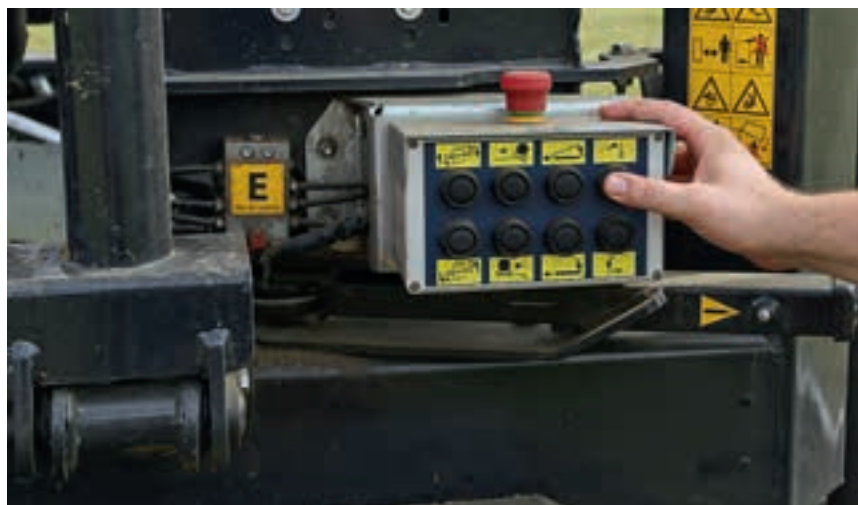
Βασικές λειτουργίες όπως η θήκη της μεμβράνης μπορούν να χρησιμοποιηθούν από τα έξω χειριστήρια.
