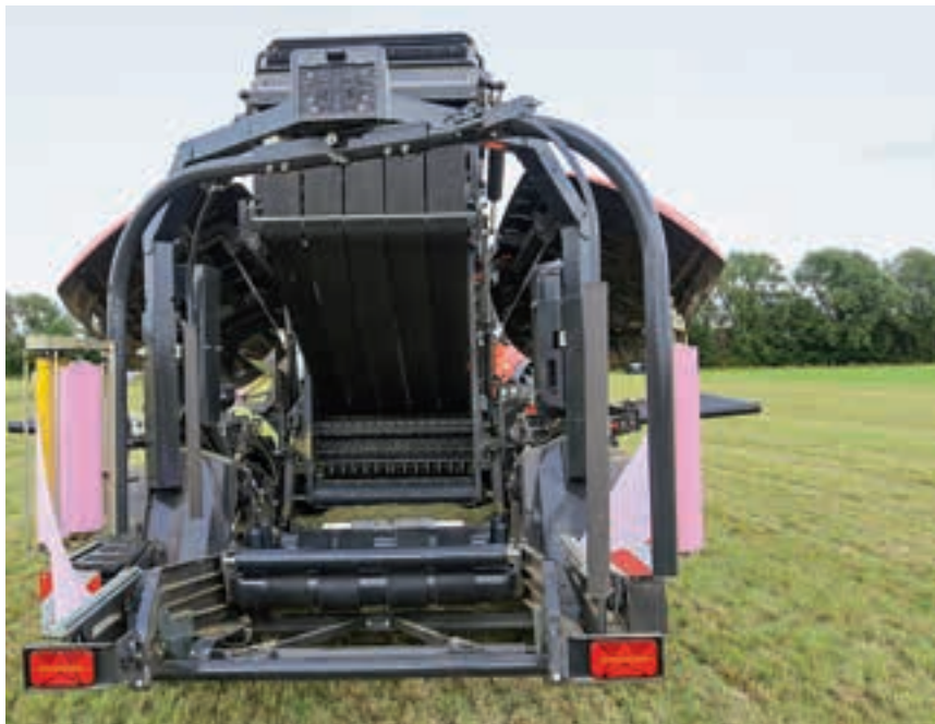
Ένας μεγαλύτερος υδραυλικός κινητήρας τροφοδοτεί τώρα τους βραχίονες τυλίγματος, φέρνοντας απόδοση.
