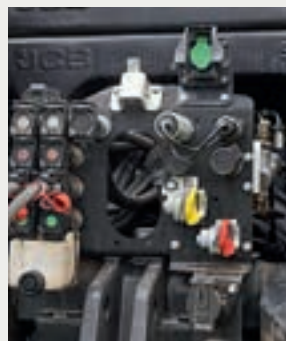
Οι ζεύκτες είναι πολύ στενοί και δεν διαθέτουν μοχλό εκτόνωσης πίεσης.
