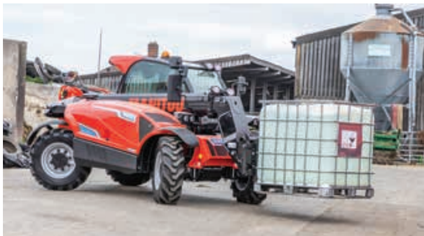
Η έλλειψη εξάτμισης και μπλε αυτοκόλλητα δείχνουν ότι το MLT 625e διαθέτει μπαταρία.
