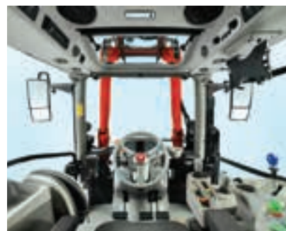
Στην πιο ολοκληρωμένη διαμόρφωση περιλαμβάνεται ένα υδραυλικό σύστημα ανίχνευσης φορτίου 120 λ/λεπτό με έως και 10 πίσω ζεύκτες, μηχανικά και ηλεκτρονικά χειριστήρια.
