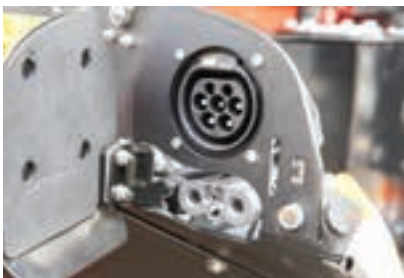
Δύο θύρες φόρτισης προσφέρουν επιλογές AC και DC, με δυνατότητες από ταχυφόρτιση σε μία ώρα έως και πιο φόρτιση σε 11 ώρες.
