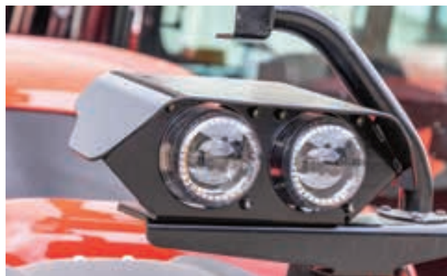
Τμήματα χαμηλής κατανάλωσης ενέργειας όπως είναι οι προβολείς LED αξιοποιούν στο μέγιστο δυνατό την μπαταρία ισχύος 35kWh.
