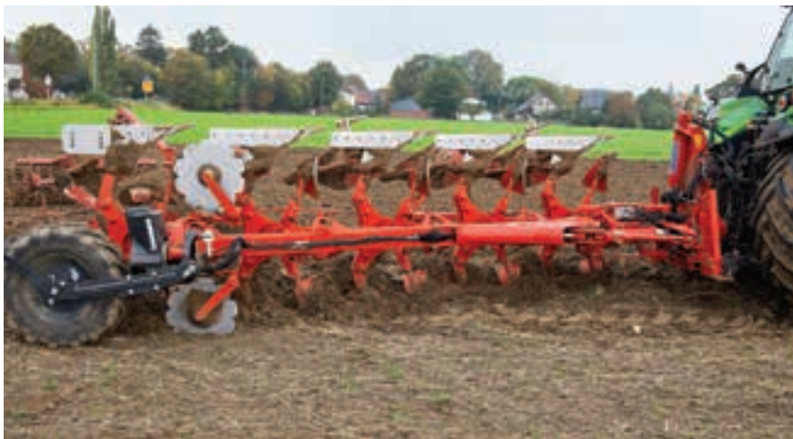
Ο μεγάλος τροχός μπορεί να λειτουργήσει επίσης και ως τροχός μεταφοράς στο δρόμο.
