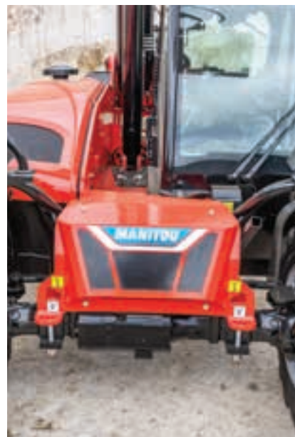
Φτιάχνοντας δική της μπαταρία η Manitou την ενσωμάτωσε στη μέση του σασί MLT.
