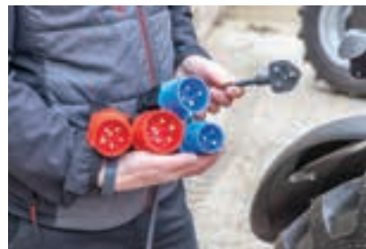
Ένας φορτιστής 9kW στο μηχανήμα δίνει μια μεγάλη ποικιλία επιλογών συνδεσιμότητας από 1ας φάσης 240volt ως 3 φάσεις 16 amp.
