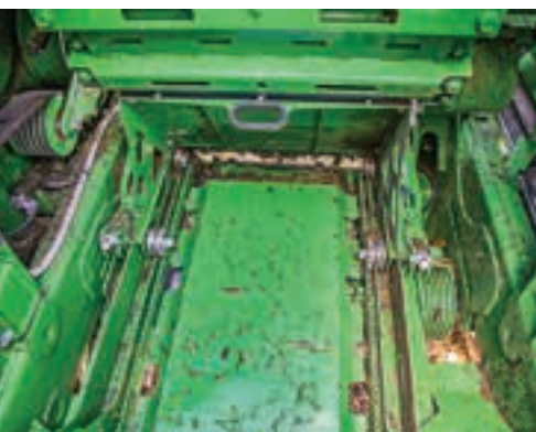
Το σύστημα rail για το σπαστήρι είναι καινούργιο χαρακτηριστικό.
