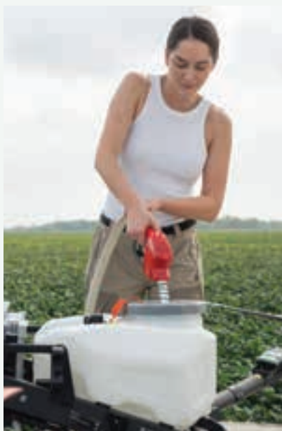
Το drone διαθέτει δεξαμενή ψεκασμού 50 λίτρων, δοχείο διασποράς έως 55 κιλά και πλήρως αυτοματοποιημένη λειτουργία.
