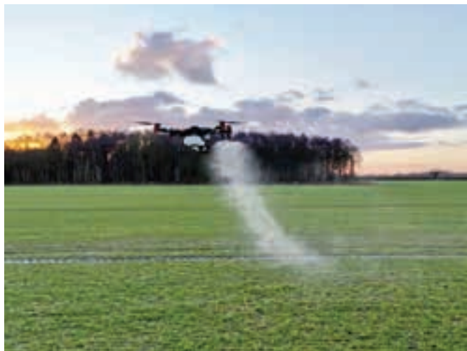
Εφαρμογή μαγγανίου μεταβλητής δόσης μέσω του δοχείου ψεκασμού.
