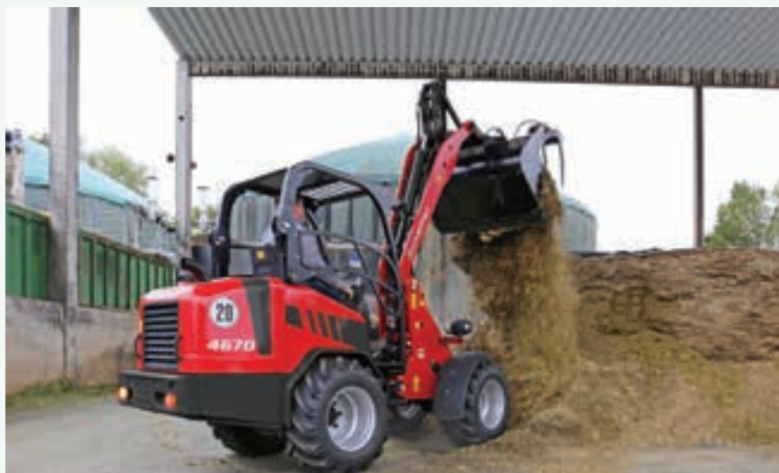
Ο Schäffer 4670 διατηρεί συνολικό πλάτος από 1,42 μέτρα και ύψος 2,27 μέτρα. Η πλήρως υδραυλική αρθρωτή διεύθυνση του επιτρέπει να κινείται με ακρίβεια σε περιορισμένους χώρους.
