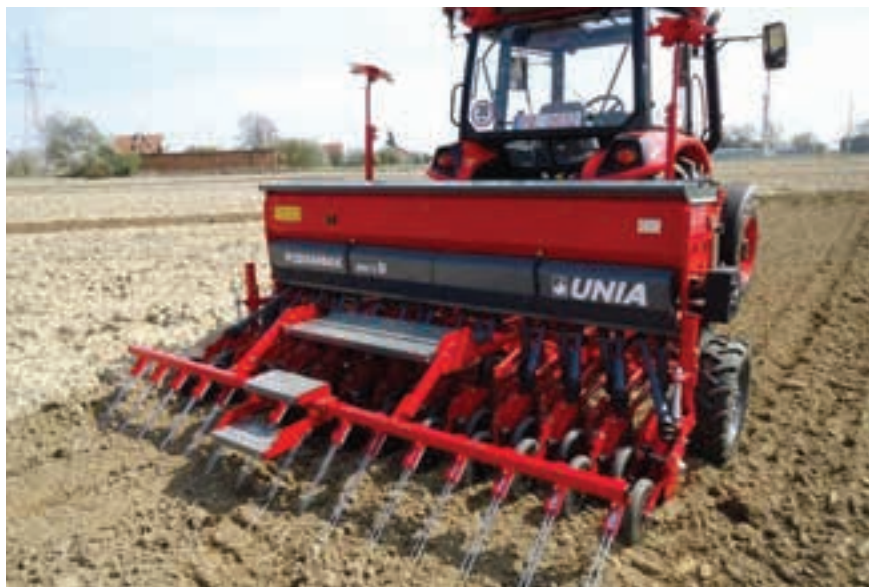
Η POZNANIAK 510/3 διαθέτει πλάτος εργασίας 3 μέτρων και χοάνη χωρητικότητας 510 λίτρων. Μπορεί να εξοπλιστεί είτε με υνάκια Suffolk είτε με διπλούς δίσκους SHELL.
