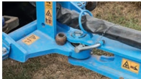
Η κεφαλή σε θέση αποθήκευσης. Ο ανώτερος σύνδεσμος είναι απαραίτητος για να ασφαλίσει την κεφαλή τριών σημείων και να αποτραπεί η πτώση.
