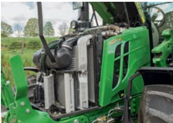
Προκειμένου να δοθεί στο καπό αυτός ο λεπτός σχεδιασμός, οι ανεμιστήρες είναι διατεταγμένοι σε τέσσερα μέρη.
