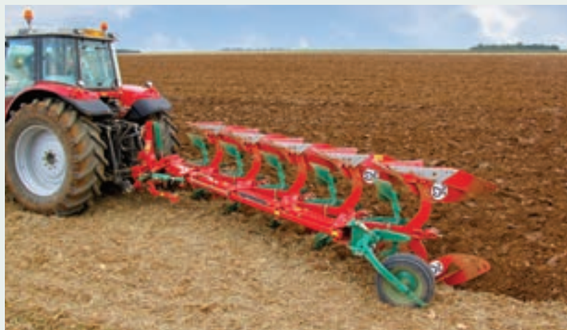
Το κυρίως πλαίσιο είναι 150x150x6,4mm κάνει το άροτρο στιβαρό ώστε να αντέχει κάτω από οποιοσδήποτε συνθήκες εργασίας.
