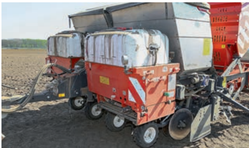
Το σύστημα εφαρμογής στην φυτευτική μηχανή MS4000 περιλαμβάνει ένα ζευγάρι δεξαμενών χωρητικότητας 400 λίτρων, ενώ το λίπασμα βρίσκεται σε χοάνη η μπορεί να φιλοξενήσει 2.200 λίτρα από αυτό.
