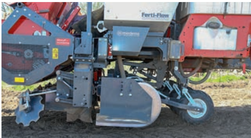
Οι τροχοί μετρητή στο μπροστινό μέρος ελέγχουν το ύψος των μαχαριών λιπάσματος μαζί με το ανοιχτήρι αυλακιού που ακολουθεί από πίσω. Ρυθμός εφαρμογής: 100 κιλά/10 στρέμματα και 2000 κιλά/10 στρέμματα.
