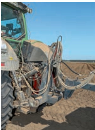
Η κεφαλή σύνδεσης τριών σημείων του MS 4000 με κοτσαδόρο K80 που παίρνει ρόλο άξονα.
