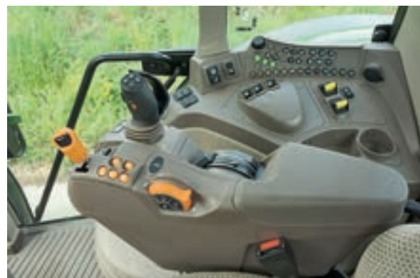
Η έκδοση «premium» έχει υποβραχιόνιο πολλαπλών λειτουργιών CommandArm με κιβώτιο CommandQuad και ηλεκτρικά καρούλια.
