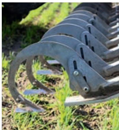
Τα καλύβδινα πεδία ελέγχουν το βάθος. Η γωνία και το βάθος ορίζονται από μακρόστενες οπές.
