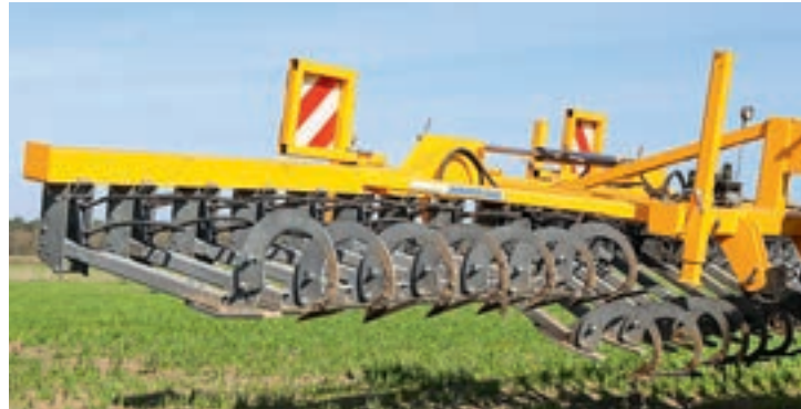
Αυτή η τσάπα έχει τρία τμήματα και το καθένα ανυψώνεται και χαμηλώνει αυτόνομα.
