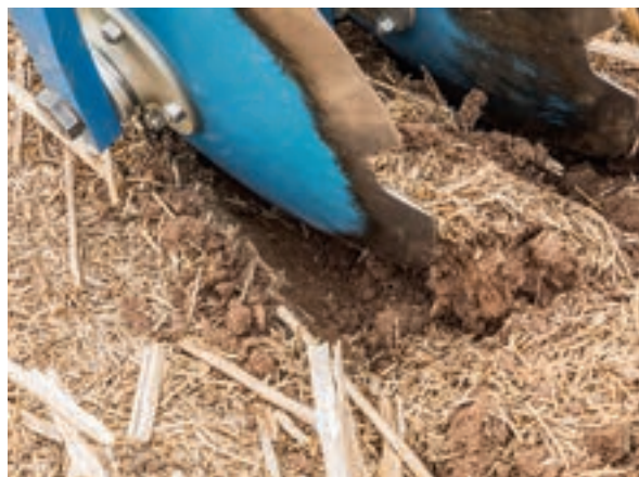
Οι οδοντωτοί δίσκοι των 645 χιλιοστών έχουν βάθος 5-13 εκατοστά.
