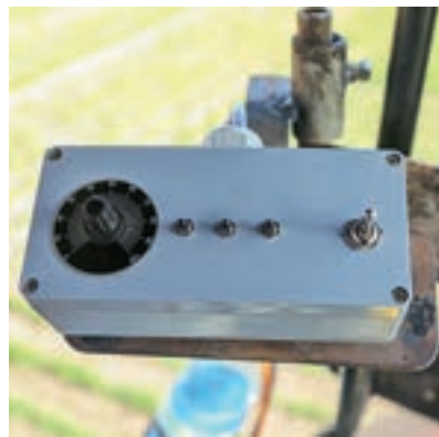
Ο περιστρεφόμενος διακόπτης ελέγχει την πίεση στα δόντια και τα άλλα κουμπιά τα τμήματα και την αναδίπλωση.
