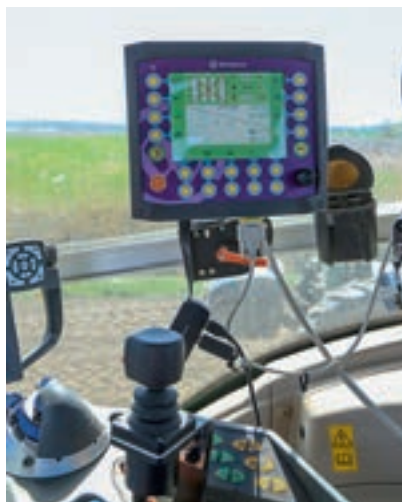
Το MS4000 λειτουργεί μέσω του τερματικού HMI και του χειριστηρίου.
