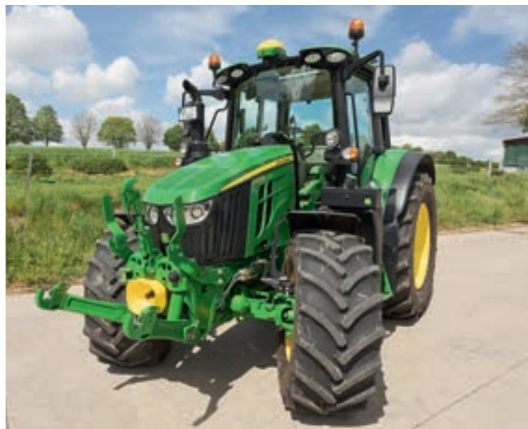
Ο μπροστινός σύνδεσμος έχει πολύ καλή απόδοση, ανυψώνει 3,4 τόνους και πήρε πολύ καλές κριτικές.
