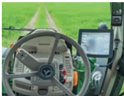
Μια πολύ ευανάγνωστη οθόνη έχει αντικαταστήσει τον πίνακα οργάνων.
