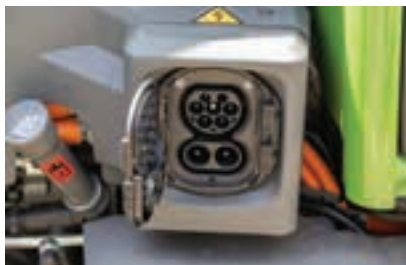
Η θήρα φόρτισης είναι συμβατή με CCS2, και έχει υποδοχή AC και DC.
