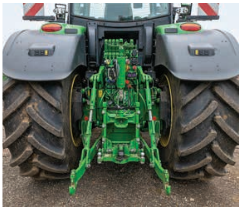
Πέντε κοτσαδόροι και σύνδεσμοι Power Beyond
