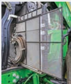
Γρήγορο καθαρίσμα της ψυκτικής μονάδας.
