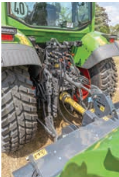
Ο πίσω σύνδεσμος είναι ίδιος με του πετρελαιοκίνητου 207 Vario.
