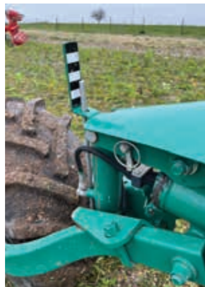
Οι χειριστές μπορούν να τροποποιήσουν υδραυλικά το βάθος εργασίας της Kverneland.
