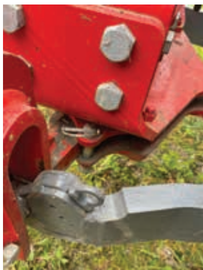
Οι πείροι στον χαμηλό άξονα του αρότρου Kverneland αφαιρούνται κατά τη μεταφορά για να μπορεί το μηχάνημα να ακολουθεί το τρακτέρ σαν παρελκόμενο.
