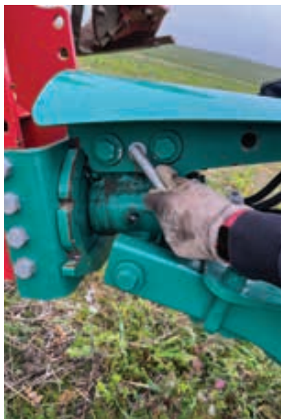
Ένας πείρος τοποθετείται για να κλειδώσει το Ecomat σε θέση μεταφοράς.
