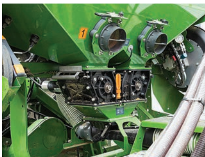
Οι δύο μονάδες δοσομέτρησης είναι τοποθετημένες η μία δίπλα στην άλλη.
