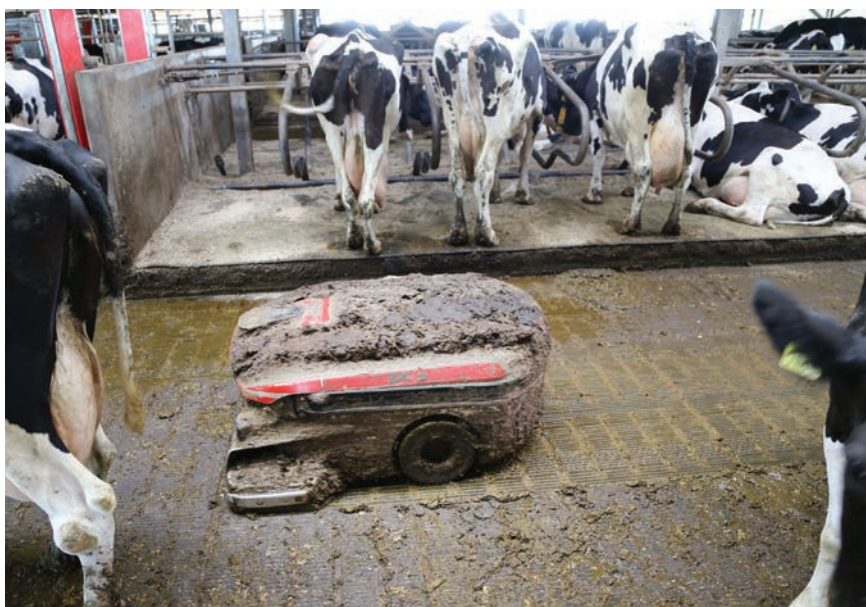
Ένα Lely Discovery Collector συλλέγει τη στέρεη κοπριά από τον κύριο χώρο.
