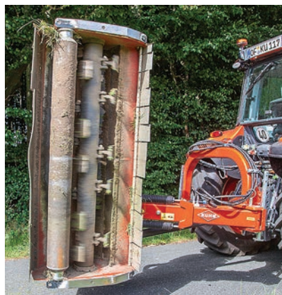
Πέντε σφυριά είναι αναρτημένα σε κάθε σειρά. Στρίβουν στις 2.325 σ.α.λ. (ταχ. 540).
