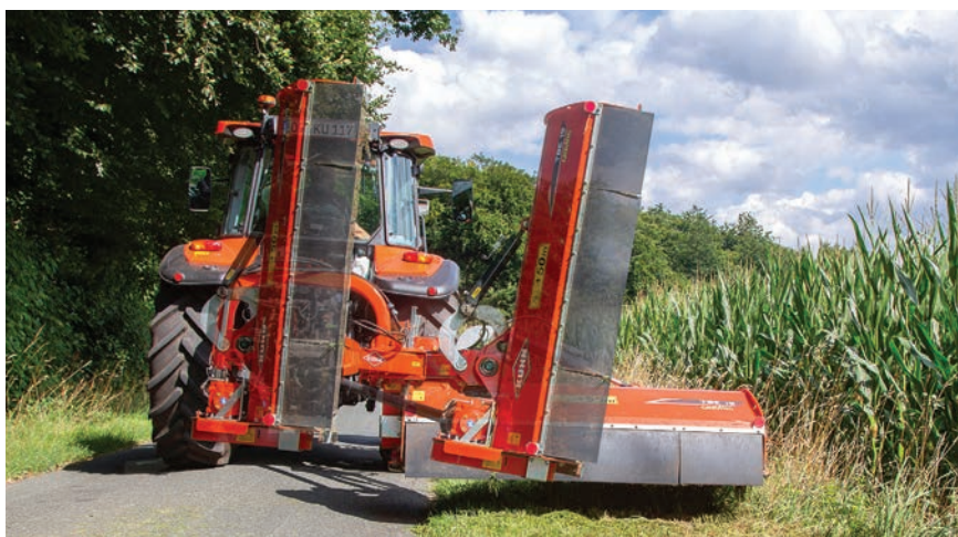
Ο βραχίονας κινείται 1,59 μέτρα στο πλάι. Αξιόλογο διάνυσμα που δείχνει την ευελιξία του TBE.
