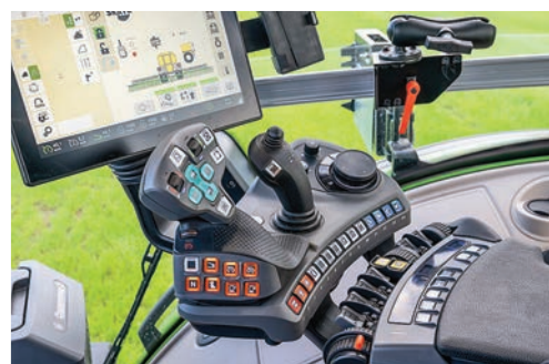
Το πλήκτρο TMS-Flex βρίσκεται δίπλα στο ουδέτερο (N) πλήκτρο. Τα υπόλοιπα είναι ίδια με άλλα τρακτέρ Vario.
