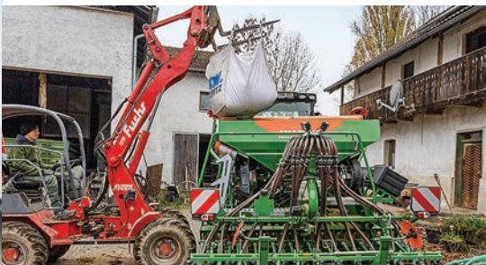
Το ύψος γεμίσματος είναι 2,25μ., κοντά στα όρια του φορτωτή της φωτογραφίας.
