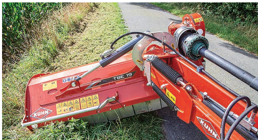
Ένα ζευγάρι ελατηρίων τεντώνει τον βραχίονα. Αν υπερφορτωθεί, το κοπτικό κινείται πίσω.
