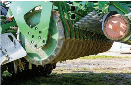
Ο 3.0μ. τραπεζοειδής κύλινδρος ζυγίζει 665κ.. Δεν είναι ελαφρύς, αλλά κάνει εξαιρετική δουλειά στο να υποστηρίξει το μηχανήμα.
