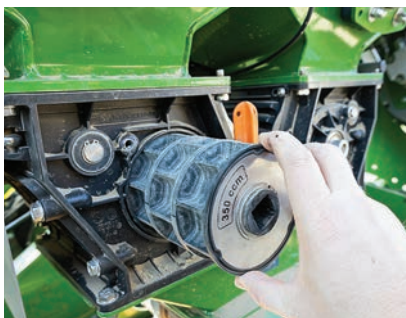
Η αλλαγή των τροχών δοσομέτρησης είναι εύκολη, αλλά θέλει προσοχή μερικές φορές.
