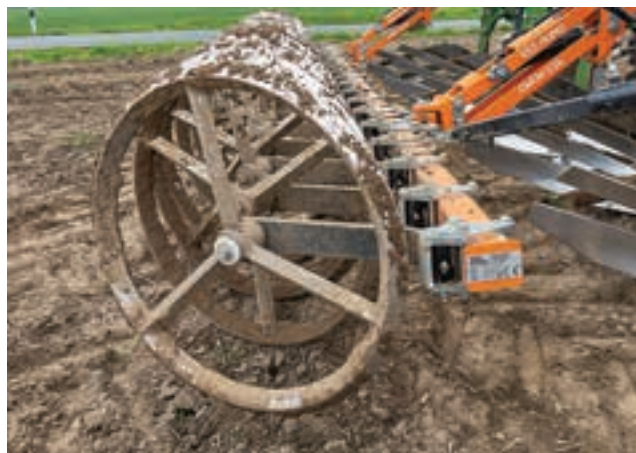
Οι δακτύλιοι είναι σε ανεξάρτητους βραχίονες. Μπορούν να προσαρμοστούν άμεσα στο κάθε έδαφος.
