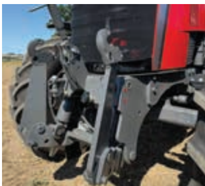
Ο μπροστινός σύνδεσμος μπορεί να λειτουργήσει από μεσαία ανάρτηση ή τον πίσω κοτσαδόρο αναλόγως των υδραυλικών.
