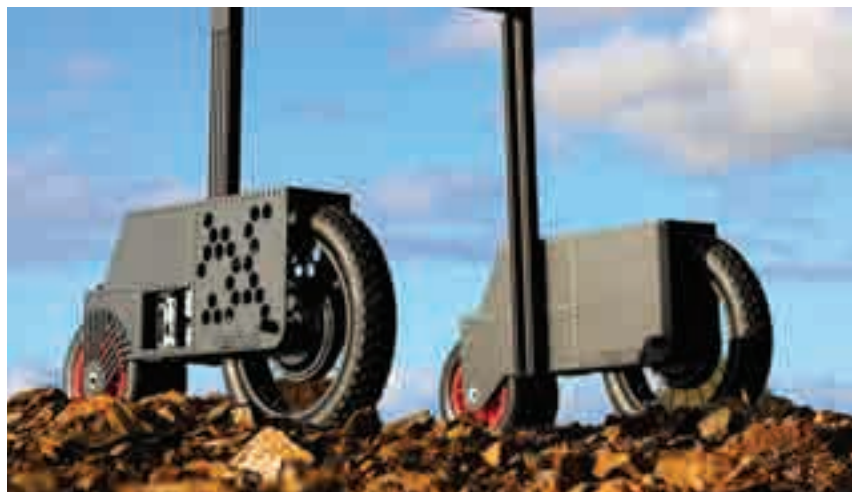
Τροχαί, ανάρτηση και υπολογιστής, που όλα μαζί συγκροτούνται από ένα γαλβανισμένο σωλήνα στον οποίο μπορεί να ρυμωληθεί ή να προσαρτηθεί μια ποικιλία εργαλείων. Το πιο απλό αγροτικό ρομπότ έρχεται στην αγορά από την RTU.
