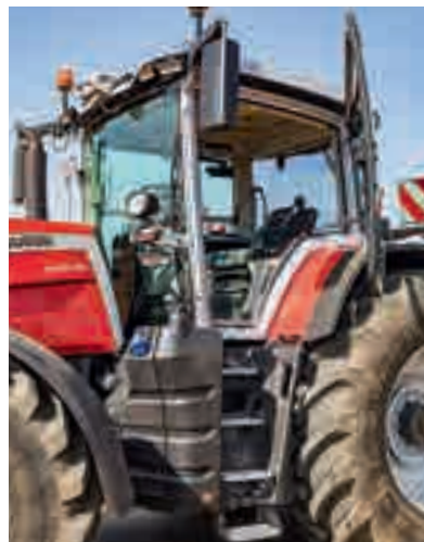
Υπάρχει ένα μεγάλο κενό 24 εκ. μεταξύ του καπό και της καμπίνας για τη μόνωση της τελευταίας τόσο από θόρυβο όσο και από θερμότητα.
