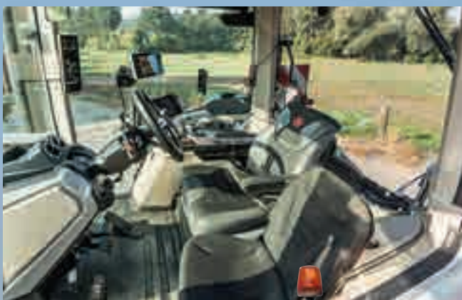
Θέα με επιφάνεια 6,6m 2 από γυαλί και χαμηλό επίπεδο θορύβου που είναι μόλις 68dB εντός της ευρύχωρης καμπίνας..
