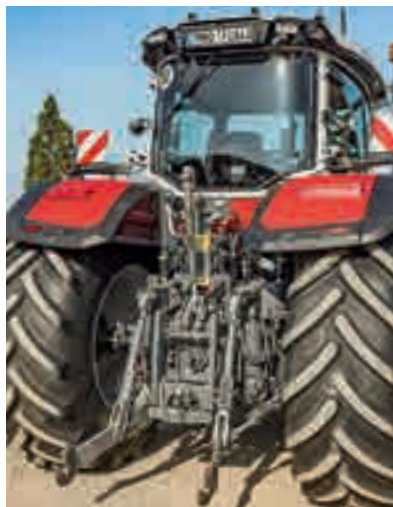
Ο πίσω άξονας και τα υδραυλικά είναι κοινά με εκείνα της Fendt. Η καμπίνα διαθέτει μηχανική ανάρτηση ή, προαιρετικά, ενεργή μηχανική.
