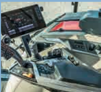
Το χειριστήριο μπορεί να εκτελέσει διαφορετικές λειτουργίες μέσω του ISObus.
