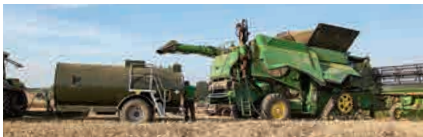
Το όχημα ανεφοδιασμού του αγροκτήματος χωρά 7.000 λίτρα καυσίμου και 1.000 λίτρα AdBlue.
