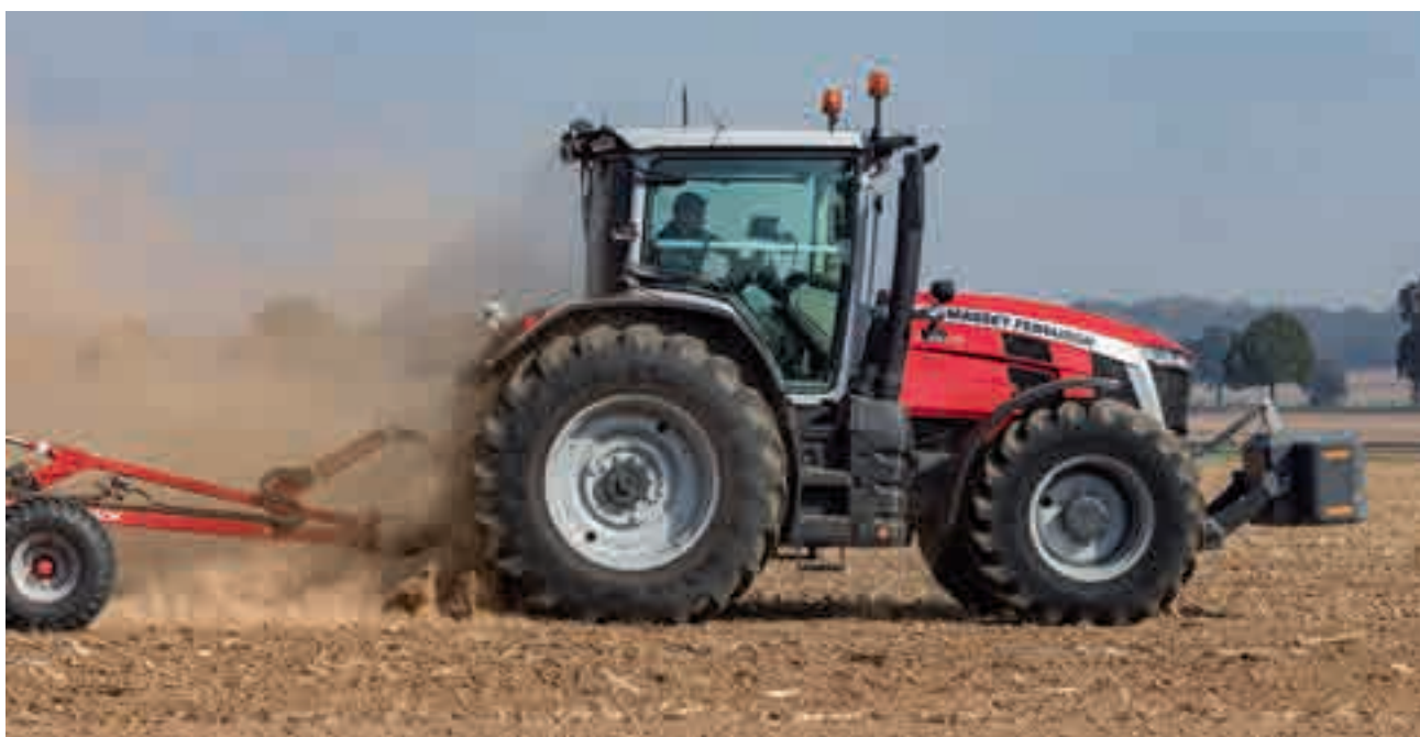
Η μετάδοση E-Power τα κάνει όλα μόνη της όταν το 8S έχει καθήκοντα στο πεδίο. Όλα αυτά χωρίς διακοπή ισχύος από τη σχέση 1 στη σχέση 28.
