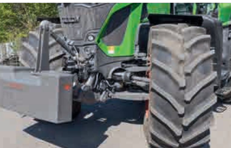
Ο μπροστινός άξονας ενεργοποιείται μόνιμα σε ταχύτητες έως 25 χλμ./ώρα
