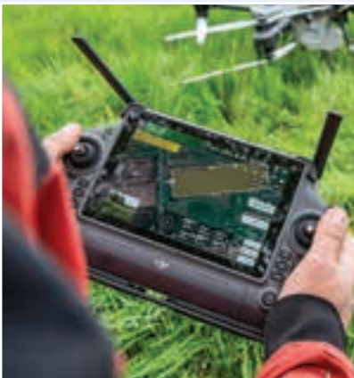
Οι οθόνες RC Plus δείχνουν τη διαδρομή πτήσης και τις παραμέτρους, καθώς και μια ζωντανή εικόνα.
