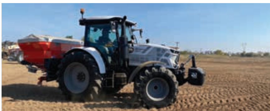
Στην επίδειξη για τη λιπασματοδιανομή ακριβείας συμμετείχε το μηχανήμα Rauch AXIS M 30.2 EMC +W, το οποίο είχε αναρτηθεί στο τετρακύλινδρο τρακτέρ Lamborghini SPARK R.
