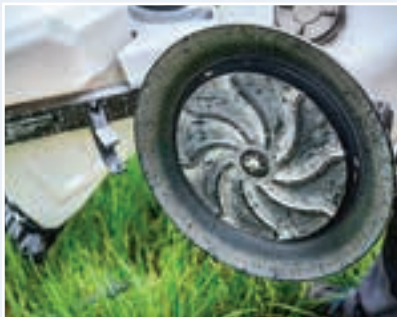
Ο ηλεκτρικά κινούμενος δίσκος διασπείρει μικρούς σπόρους και κόκκους.
