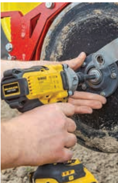
Οι τροχοί ελέγχου βάθους και οι δίσκοι κοπής μπορούν να αφαιρεθούν σε λίγα δευτερόλεπτα (αριστερά).
