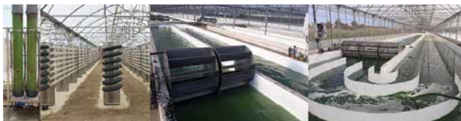
Παραγωγή Basfoliar® Spyra : Μοναδική μέθοδος παραγωγής στη βιομηχανία βιοδιεγερτών, ανοικτή δεξαμενή τύπου raceway
