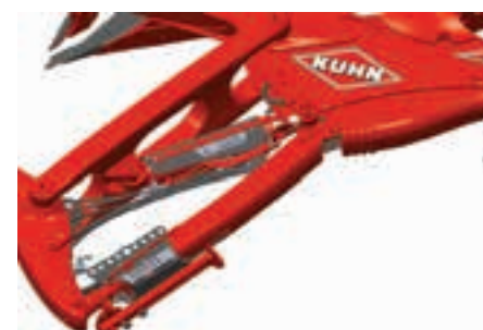
Το νέο Kuhn Vari Master On-Land, οργώνει εντός και εκτός αυλακιάς.
