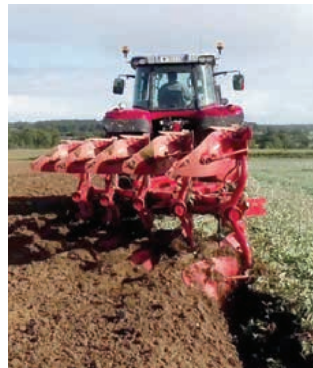
Το νέο Kuhn Vari Master On-Land, οργώνει εντός και εκτός αυλακιάς.
