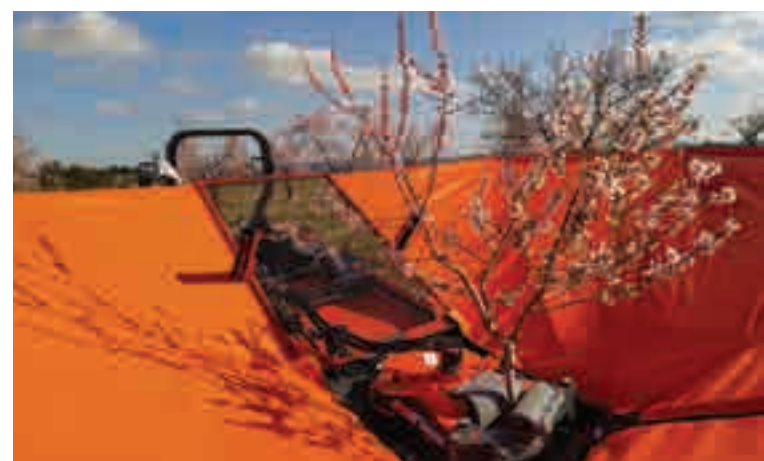
Ανάμεσα στα πλεονεκτήματα του VTS είναι το σωληνοειδές πλαίσιο προστασίας της πλατφόρμας.
