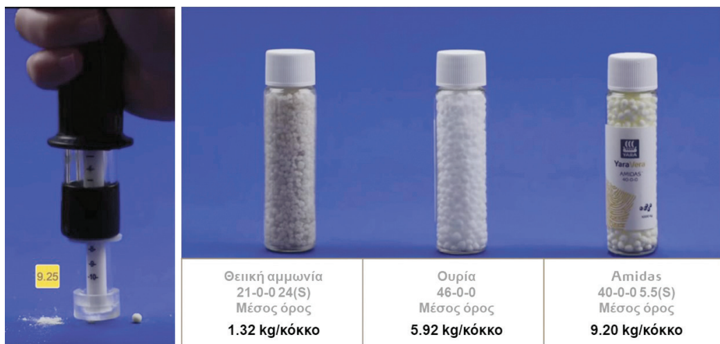
Μέτρηση σκληρότητας του YaraVera AMIDAS συγκριτικά με την ουρία και τη θειική αμμωνία
