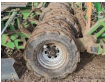
Κάθε ελαστικό έχει ξεχωριστή ανάρτηση. Οι τροχοί είναι τώρα στοιχισμένοι σε ζεύγη.
