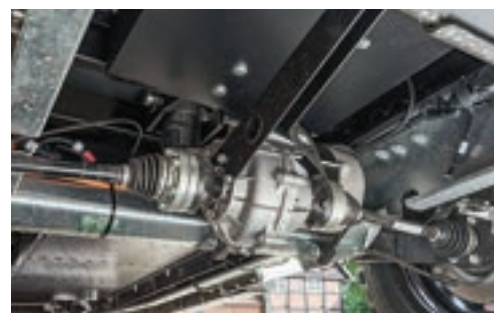
Κάθε άξονας έχει το δικό του ηλεκτρικό μοτέρ για πλήρη τετρακίνηση σε δύσκολα εδάφη.
