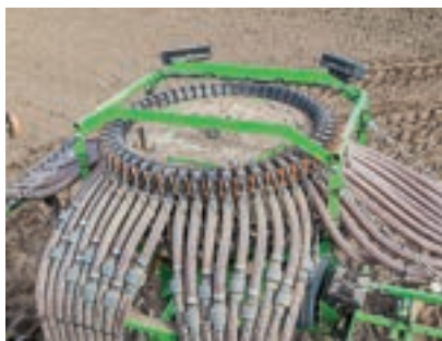
Κάθε μία από τις 54 εξόδους διαθέτει το δικό της ηλεκτρικό πτερύγιο.
