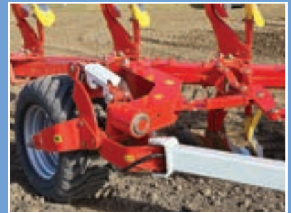
Το υδραυλικό σύστημα αλλαγής πλάτους μεταξύ του πίσω τροχού και της δοκού.
