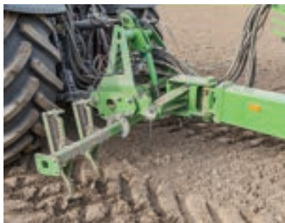
Μηχανισμοί εξάλειψης τροχιάς σε ξεχωριστό πλαίσιο τριπλής σύνδεσης.
