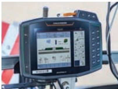
Λειτουργίες όπως το βάθος σποράς και η πίεση ρυθμίζονται από το τερματικό ελέγχου.
