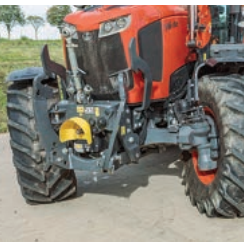
Ο άξονας φέρει ανάρτηση και το BiSpeed εξασφαλίζει ακτίνα στροφής 9,70 μ.
