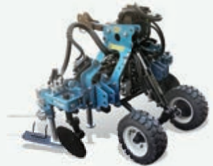
Τα αμπελουργικά μηχανήματα τύπου τρόλεϊ διαθέτουν αυτόνομη υδραυλική εγκατάσταση.
