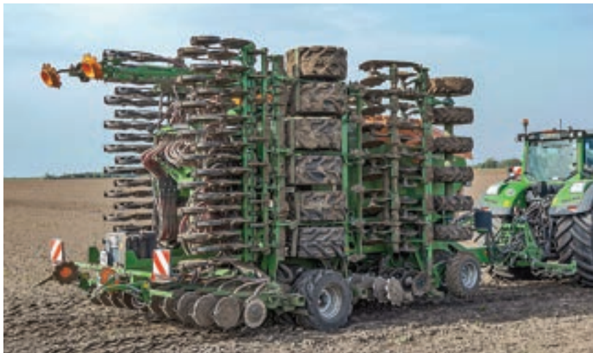
Διπλωμένη, η σπαρτική καταφέρνει να έχει πλάτος κάτω από 3 μέτρα και ύψος 4 μέτρα.
