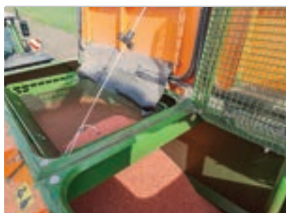
Η χοάνη χωρίζεται 60:40, με το διαχωριστικό να βρίσκεται υπό γωνία.
