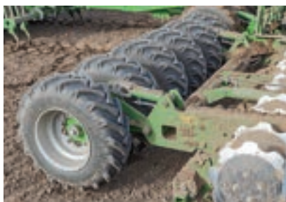
Κάθε στοιχείο του τυπικού εμπρόσθιου συσκευαστή έχει τον δικό του άξονα.
