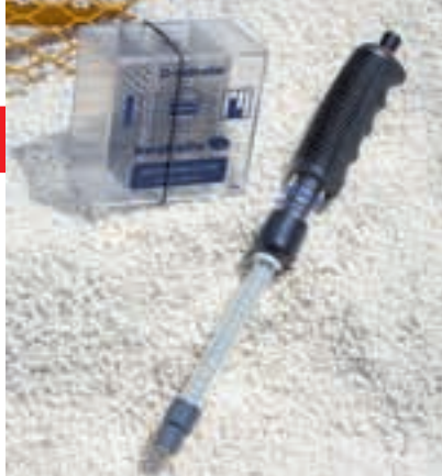
Ο μετρητής για το μέγεθος των σωματιδίων και ο ανιχνευτής αντοχής για τη δύναμη σύνθλιψης.
