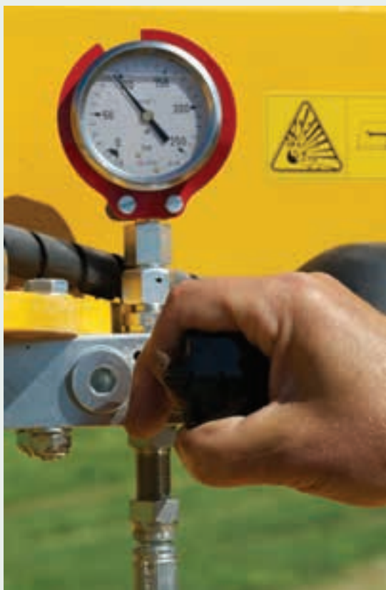
Ο μοχλός δίπλα από τον μετρητή πίεσης χρησιμοποιείται για να ρυθμιστεί η ανάρτηση στο επιθυμητό σημείο.
