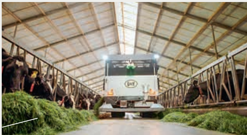
Το Exos κόβει έως και 1.000 κιλά χορταριού, τα οποία παρέχονται αυτόματα ως τροφή για τα ζώα.
