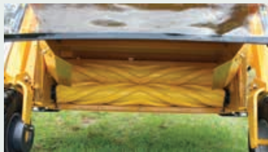
Οι κύλινδροι σύνθλιψης με ελικοειδείς ραβδώσεις και το σύστημα ανάρτησης δεν σπάνε (δεν τσαλακώνουν) το σώμα της χορτονομής.
