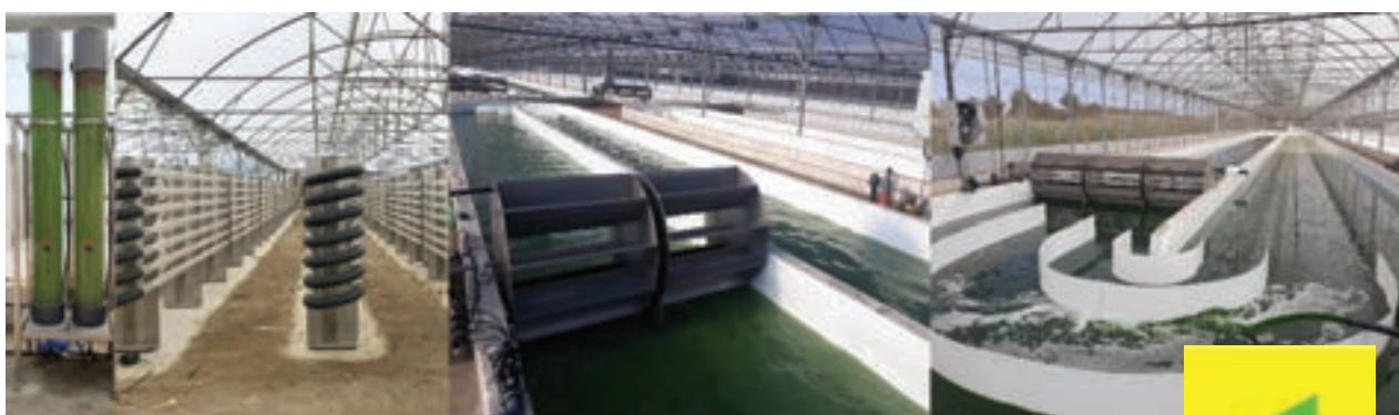
Παραγωγή Basfoliar® Spyra: Μοναδική μέθοδος παραγωγής στη βιομηχανία Βιοδιεγερτών η οποία αξιοποιεί μία ανοικτή δεξαμενή τύπου raceway.
