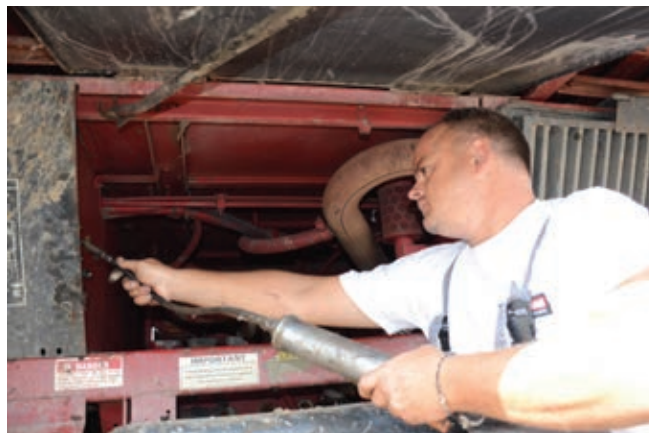
Ο βαμβakoπαραγωγός και ιδιοκτήτης βαμβakoσυλλεκτικής μηχανής Κώστας Ζιώγας γρασάρει την τουρμπίνη του αέρα που δίνει ώθηση στο βαμβάκι να ανεβεί στο καλάθι.
