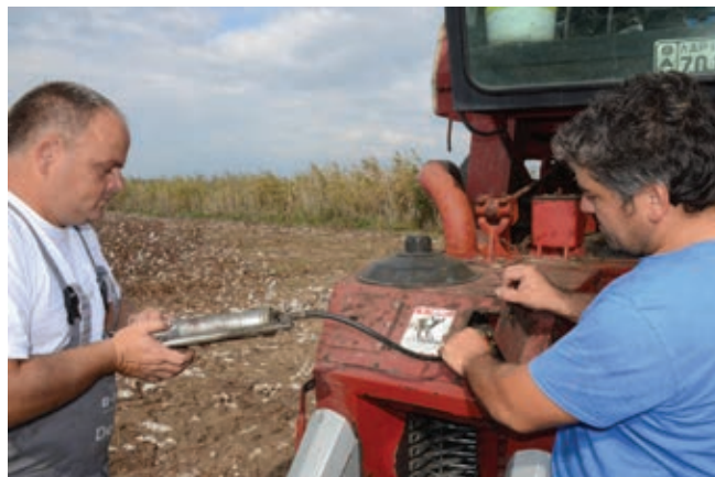
Οι Κώστας Ζιώγας και Θεόδωρος Ντόντος γρασάρουν τα ράουλα του συλλεκτικού ανά 8 ώρες για τη σωστή λειτουργία της μηχανής.
