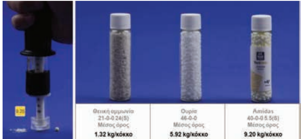
Μέτρηση σκληρότητας του YaraVera AMIDAS συγκριτικά με την ουρία και τη θεική αμμωνία
