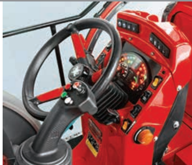
Το ταμπλό είναι ψηφιακό, με όλες τις λειτουργίες -μαζί και τις τέσσερις ρυθμίσεις της εμπρόσθιας κίνησης- να είναι προσβάσιμες με ένα κουμπί.
