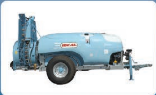
Νεφελοψεκαστήρας Perfection Ideal Ιταλίας. Είναι εξοπλισμένο με διπλή φτερωτή, διπλης περιστροφής με σκοπό την καλύτερη διανομή αέρα για εξοικονόμηση φαρμάκων και τέλει ψεκασμό.
