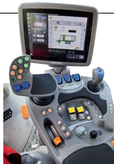
Το μπράτσο καθίσματος πολλών λειτουργιών της καμπίνας MaxiVision 2 διαθέτει οθόνη αφής 12,8 ιντσών.
