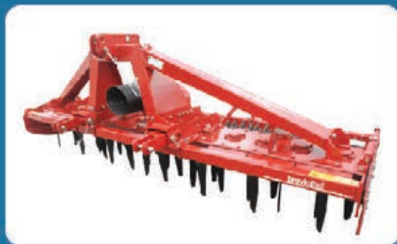
Σβολοκόπτης Breviglieri Ιταλίας Μεσαίου & Βαρέως τύπου σταθερά από 2,50 έως 4 μέτρα. Αναδιπλούμενα από 4 μέτρα έως 8 μέτρα. Όλοι οι σβολοκόπτες συνοδεύονται με οδοντωτό κύλινδρο με μηχανική ή υδραυλική ρύθμιση
