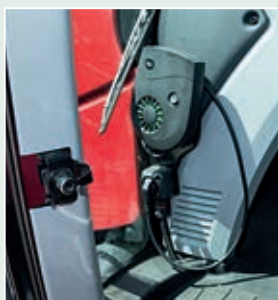
Το σύστημα προθέρμανσης κινητήρα διαθέτει πρίζα 220V στην καμπίνα. Καλό!
