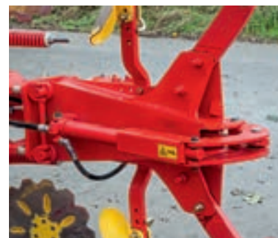
Το προαιρετικό σύστημα αναδίπλωσης Nova της Pöttinger επιτρέπει την κάθετη κίνηση των τμημάτων κατά 380 χιλιοστά.
