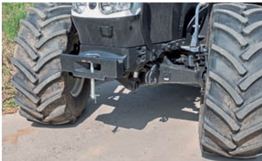
Η ανάρτηση μπροστινού άξονα είναι καινούργια και παρέχει κορυφαία άνεση στον οδηγό.
