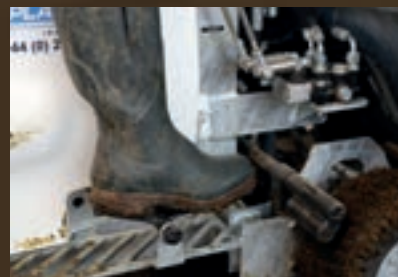
Το αναλογικό πεντάλ ζυγώθρου σας επιτρέπει να αλλάξετε από την πορεία εμπρός στην όπισθεν με το υδραυλικό σύστημα μετάδοσης.
