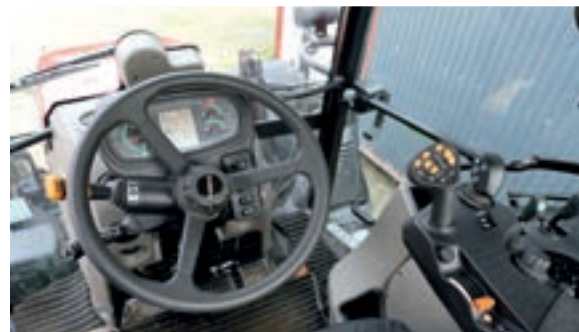
Η οθόνη περιλαμβάνει πολλές πληροφορίες. Η ηλεκτροϋδραυλική ρεβέρσα λειτουργεί από την κολόνα του τιμονιού και το μπράτσο καθίσματος.
