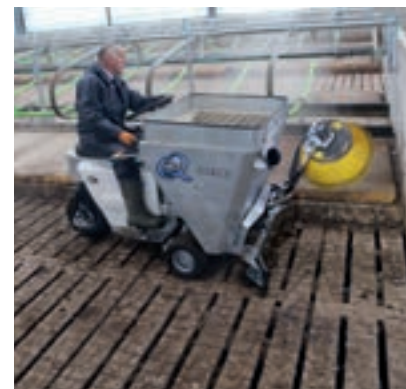
Ο βραχίονας της βούρτσας ανυψώνεται μέσω υδραυλικού συστήματος. Αφού ανυψωθεί, αποθηκεύεται για να συνεχιστεί το ξύσιμο.
