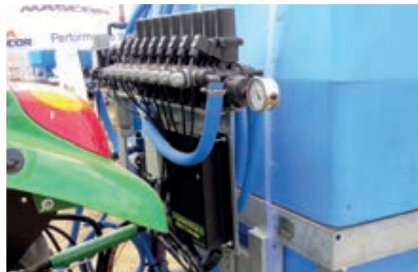
Το χειριστήριο ροής GreenStar μαζί με τους διανομείς Teejet εξοπλίζουν το ψεκαστικό.
