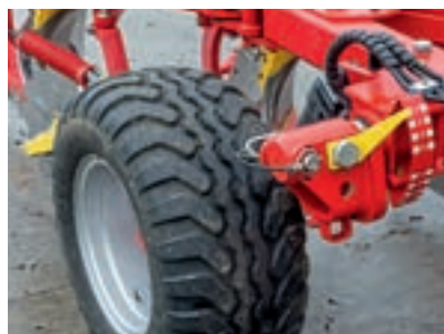
Η ρύθμιση του τροχού βάθους άρσης γίνεται μέσω υδραυλικού συστήματος.
