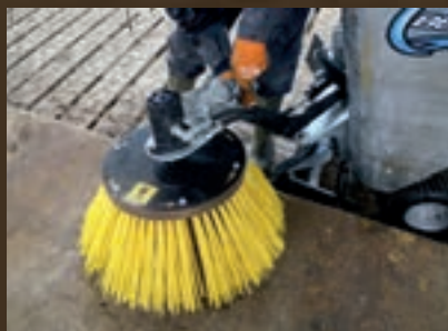
Η γωνία/μετατόπιση της βούρτσας μπορεί να ρυθμιστεί σε δύο λεπτών με κλειδί.
