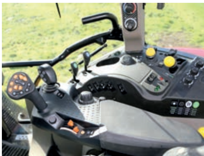
Η οθόνη περιλαμβάνει πολλές πληροφορίες. Η ηλεκτροϋδραυλική ρεβέρσα λειτουργεί από την κολόνα του τιμονιού και το μπράτσο καθίσματος.
