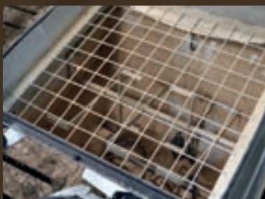
Στο κάτω μέρος της κοάνης βρίσκεται ένας σπειροειδής κοχλίας. Από πάνω βρίσκεται ένα πτερύγιο για να χαλαρώνει υλικά που κολλάνε.
