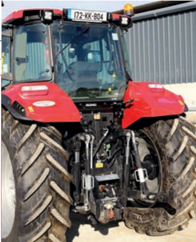
Το πίσω μέρος είναι λιτό, υπάρχουν παντού πολλά φώτα LED και αρκετό διαθέσιμο λάδι. Ο σύνδεσμος θα μπορούσε να είχε λίγη περισσότερη δύναμη ανύψωσης.
