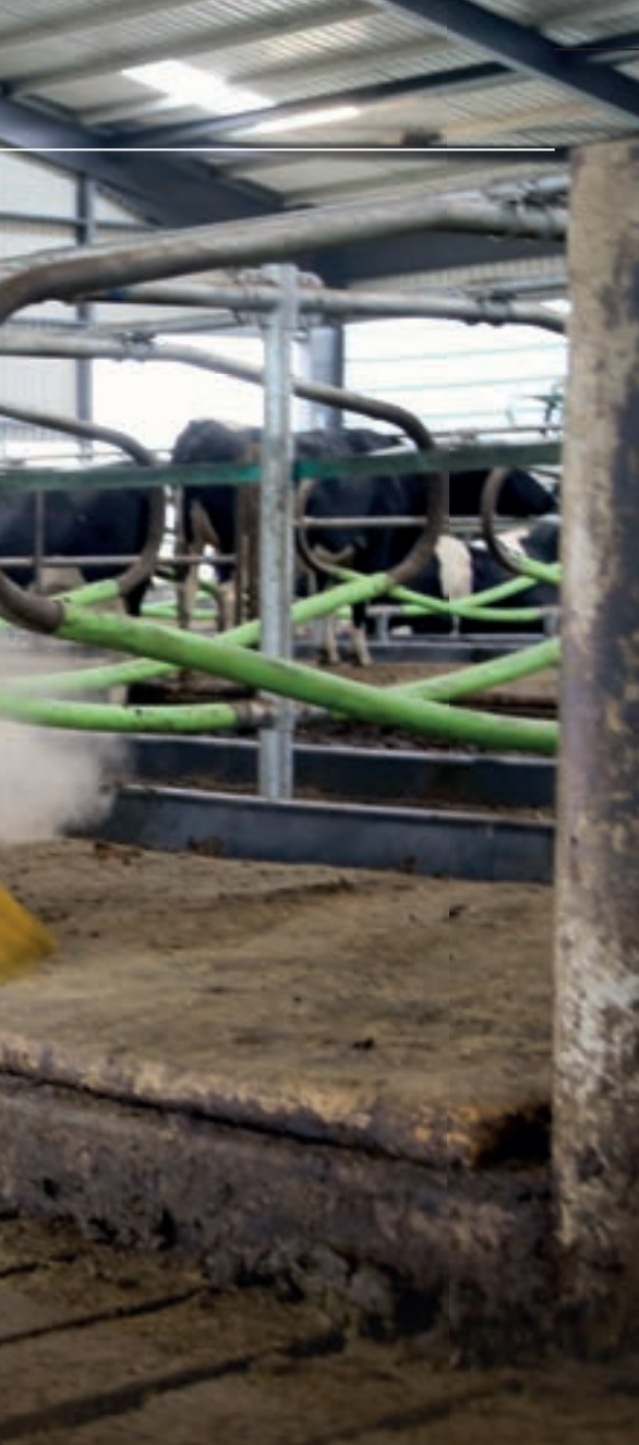
Το Q-Bed της Plantmec καθαρίζει κατά μήκος τις επιφάνειες όπου ξαπλώνουν οι αγελάδες..
