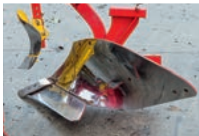
Το ελαφρύ χώμα μπορεί να πετάγεται πάνω από τον αναστρεπτήρα κατά τη βαθιά άροση.
