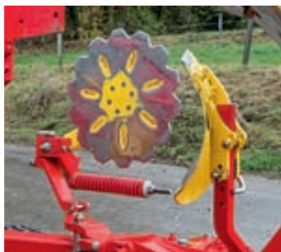
Τα μαχαίρια αρότρου με δίσκο είναι τοποθετημένα σε έναν συρόμενο τροχό.
