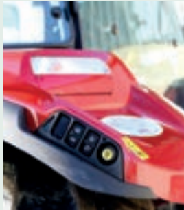
Εξωτερικά χειριστήρια ελέγχου στους πίσω λασιωτήρες.
