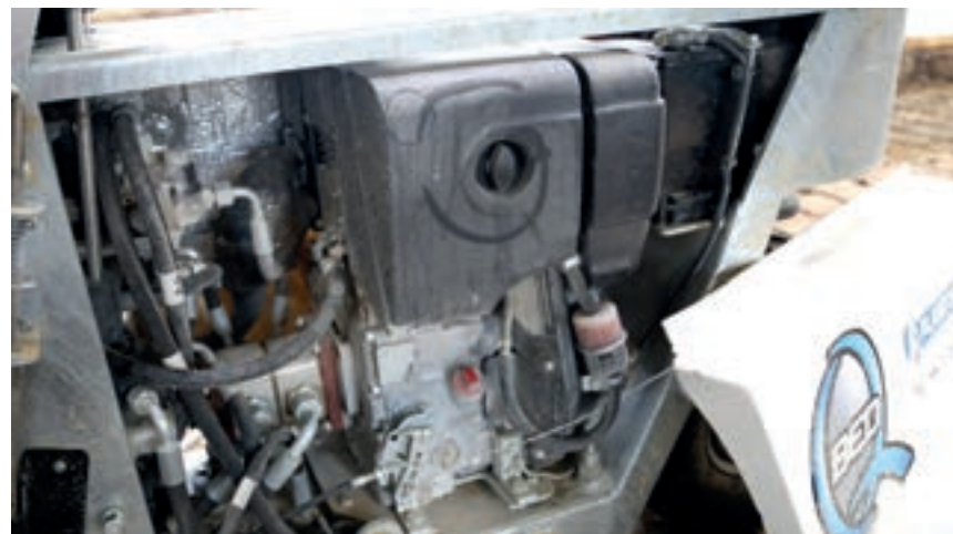
Ο κινητήρας νίζελ Hatz 10 ίππων παρέχει την απαραίτητη δύναμη. Υπάρχουν δύο υδραυλικές αντλίες: μία για το σύστημα μετάδοσης και μία για τις βοηθητικές λειτουργίες του Q-Bed. Όλο το σασί είναι γαλβανισμένο.
