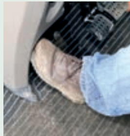
Δεν υπάρχει αρκετός χώρος για άνετη χρήση του συμπλέκτη.
