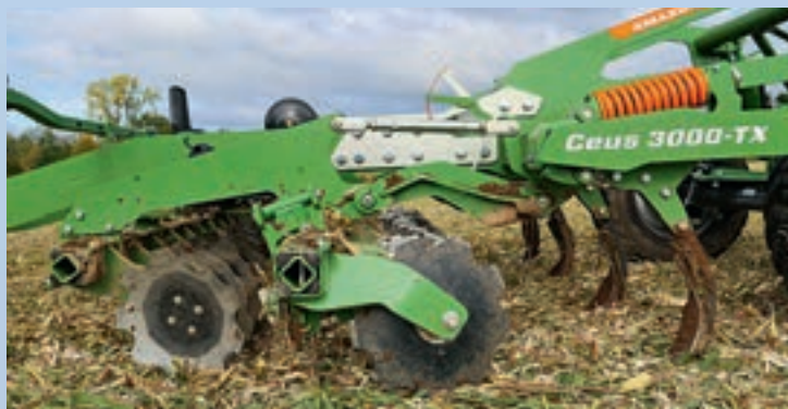
Δυο τύποι εργαλείων – δόντια και δίσκοι – εργάζονται μαζί.
