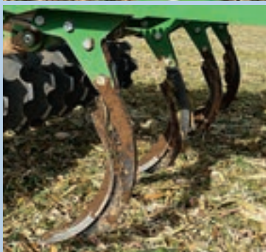
Τα δόντια «Super» διαθέτουν μηχανικό σύστημα αυτόματης επαναφοράς.
