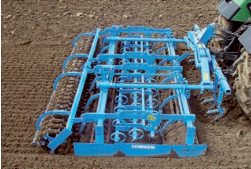
Το Kompaktor S καταφέρνει να αφήνει χωράφι έτοιμο για σπορά μειώνοντας τα περάσματα στην έκταση.
