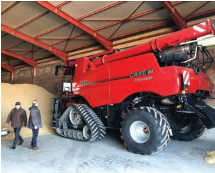
Η Chrome Edition είναι ειδικά ενισχυμένη έκδοση για των αλωνισμό του ρυζιού, με συνολική χωρητικότητα στο αμπάρι 14.400 λίτρων.
