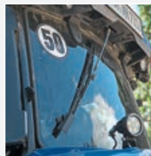
Το άγκιστρο συγκρατεί τον υαλοκαθαριστήρα.
