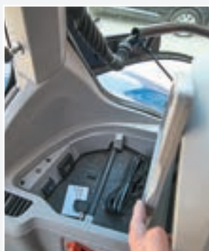
Υπάρχει ακόμη και μια πρίζα 220V μέσα στον αποθηκευτικό χώρο.
