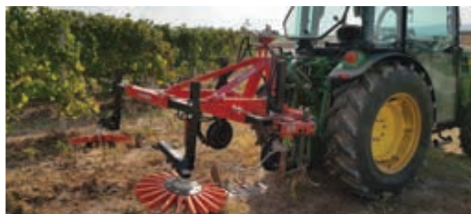
Η προσαρμογή του Fingerweeder Φ540mm, μετά από το τσαπάκι είναι ιδανική για τους καλλιεργητές που θέλουν να έχουν ένα ολοκληρωμένο κόψιμο των χόρτων.
