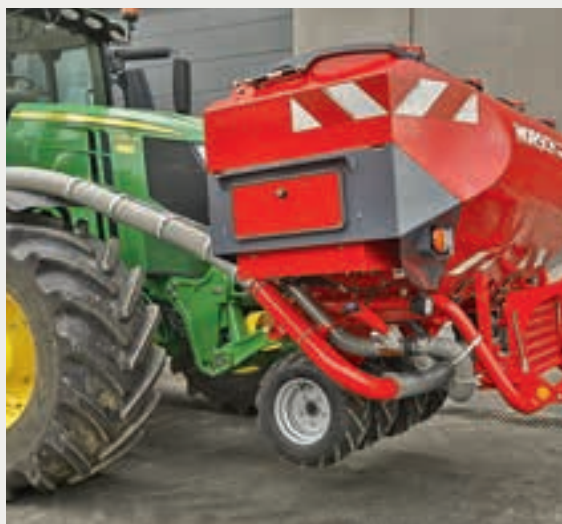
Η νέα μπροστινή χοάνη Partner 2000 της Horsch χρησιμοποιεί αέρα για να μεταφέρει υλικό στην σπαρτική. Η χωρητικότητά της, 2.200 λίτρα.
