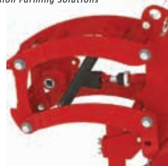
Πολλά από τα μέρη της σπαρτικής είναι κατασκευασμένα από χυτό χάλυβα υψηλής αντοχής.
