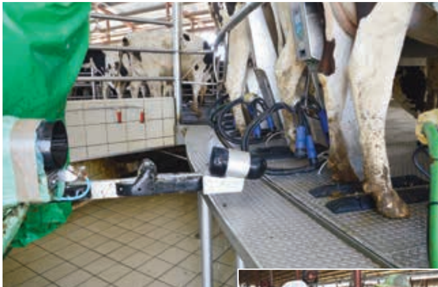
Ο ψεκασμός των θηλών μετά το άρμεγμα εκτελείται από ένα ρομπότ GSA (ΗΠΑ).
