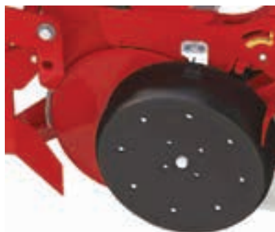
Η διάνομιξη του αυλακίου όπου εναποτίθεται ο σπόρος, γίνεται με διπλούς δίσκους μεγαλύτερης διαμέτρου (42 εκ.).
