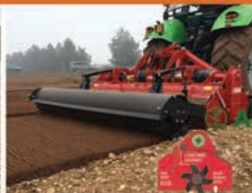
ΠΕΤΡΟΒΑΥΤΗΣ – ΣΑΜΑΡΙΤΗΣ 645HC ΥΠΕΡΒΑΡΕΟΥ ΤΥΠΟΥ ΓΙΑ ΒΑΡΙΑ ΚΑΙ ΕΝΤΟΝΑ ΠΕΤΡΩΔΗ ΕΔΑΦΗ
