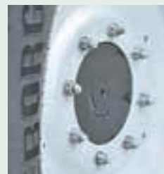
Η αφαίρεση του τροχού είναι αργή, καθώς πρέπει να ξεβιδωθούν 8 x 18 κλστ. βίδες.
