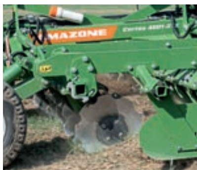
Μόνο όταν το βάθος εργασίας περάσει τα 70mm οι δίσκοι μετακινούν 4 μέτρα χώμα.
