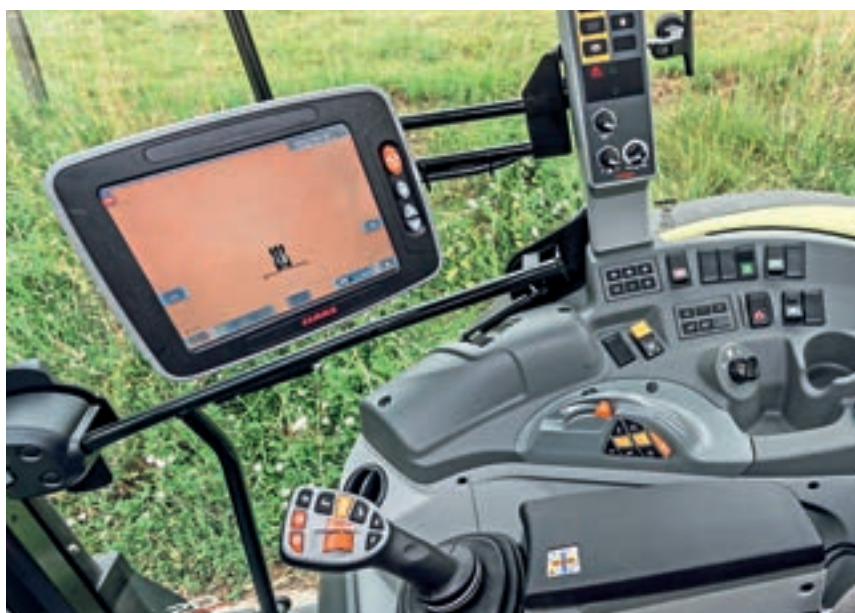
Το τζόιστικ φροντίζει τις δύο βαλβίδες πνιού και έχει κουμπιά για το σύστημα μετάδοσης, τον σύνδεσμο και τη μνήμη ταχύτητας καθώς και τρεις προσαρμοζόμενους διακόπτες - εξαιρετικά.
