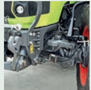
Πρακτικό, αλλά οι σωλήνες λίπανσης κινδυνεύουν με φθορά.
