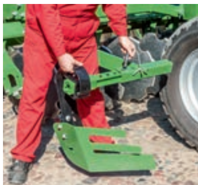
Οι πλαινές πλάκες ρυθμίζονται σε δύο επίπεδα με την αριστερή να κρέμεται από σπειροειδές ελατήριο.
