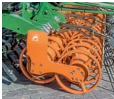
Ο συνδυασμός του προαιρετικού Crushboard, δύο σειρών δακτυλιών πρέσας με διατομή U και της σθάρνας πρόσφερε ικανοποιητικό φινίρισμα σε στελέχη από δημητριακά και καλαμπόκι.
