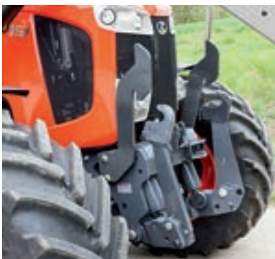
Οι κάθετοι βραχίονες προφυλάσσουν τη σχάρα του τρακτέρ, αλλά παίρνει και βελτίωση.
