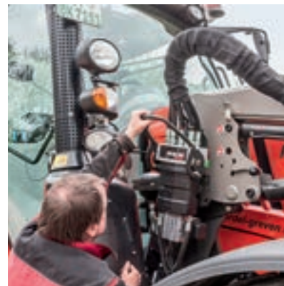
Ο πολλαπλός σύνδεσμος Mach χειρίζεται το υδραυλικό και το ηλεκτρικό σύστημα.
