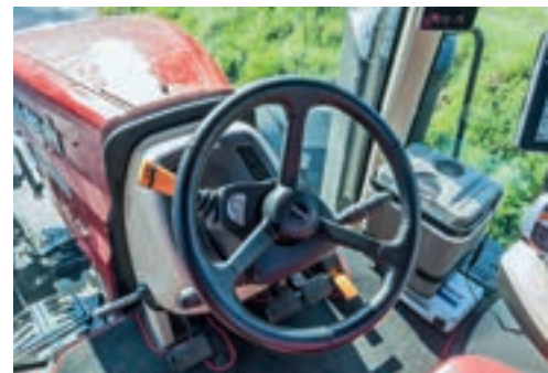
Καλό υλικό στο τιμόνι, προσεγγμένος μοχλός με θέση στάθμευσης και νέος μοχλός φλας/υπεροχο. Το ίδιο ισχύει και για το ψυχόμενο χώρο..
