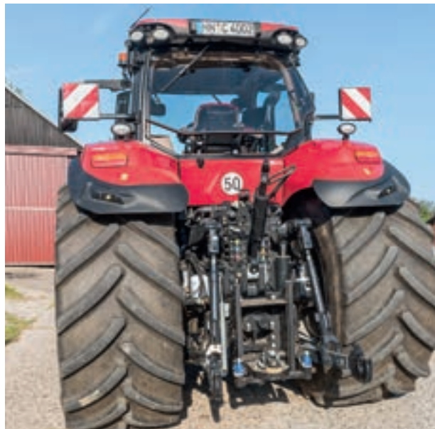
Η ισχύς ανύψωσης και η ροή λαδιού είναι εξαιρετικά, αλλά ο υδραυλικός άνω συνδέσμος, συνδεδεμένος απευθείας σε μια βαλβίδα, όχι τόσο χρηστικός.
