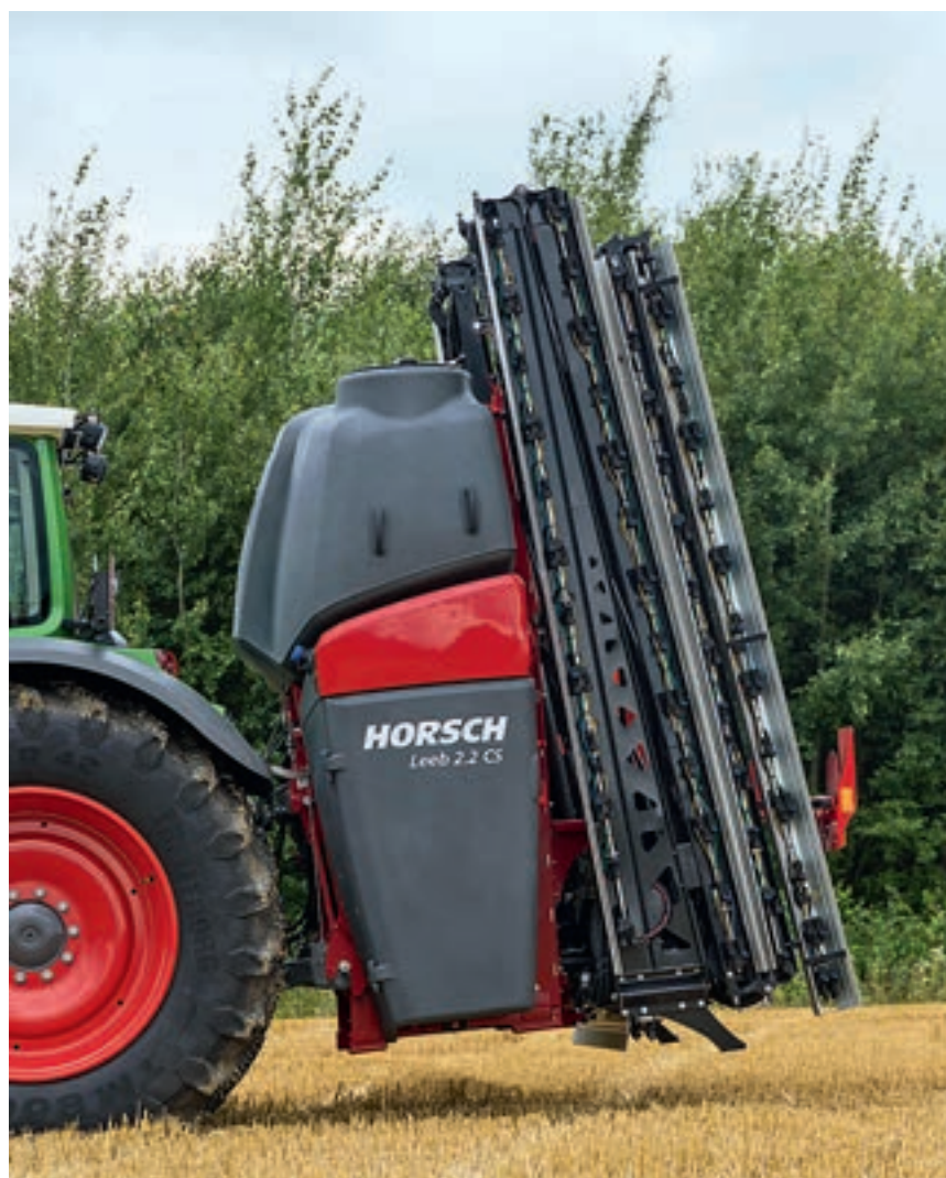
Οι βραχίονες διπλώνουν σε πλάτος 2,4 μέτρα και ύψος 3,9 μέτρα. Το εξογκωμα στην κορυφή της δεξαμενής μετακινεί το κέντρο βάρους πιο κοντά στο τρακτέρ, εξασφαλίζοντας καλή αναλογία και, κατ'επέκταση, ευελιξία.
