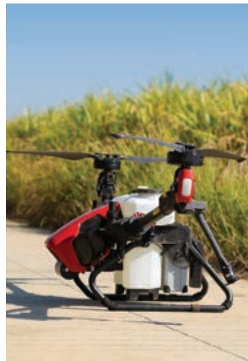
Ο σχεδιασμός διπλού έλικα εξασφαλίζει πιο συγκεντρωμένα καθοδικά ρεύματα.
