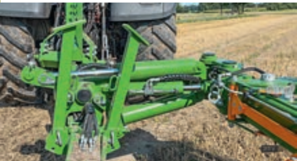
Πίσω από τον μηχανισμό αναστροφής βρίσκεται ο κύλινδρος για την υδραυλική μπροστινή αυλακιά.
