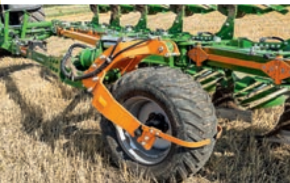
Ο τροχός ξηράς δουλεύει καλά. Ο υδραυλικός περιοριστής βάθους είναι προαιρετικός.
