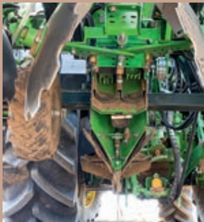
Η μανιβέλα χρησιμοποιείται για τη ρύθμιση του βάθους φύτευσης του Ceres. Το σύστημα είναι αρκετά απλό, αλλά στο μηχάνημα της δοκιμής μας η κλίμακα βάθους δεν φαινόταν εύκολα.
