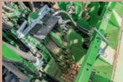
Τα πέντε ακροφύσια του εφαρμογέα έχουν σχεδιαστεί για να καλύπτουν το αυλάκι, αλλά το επιπλέον υγρό κάλυπτε όλον τον σκελετό.
