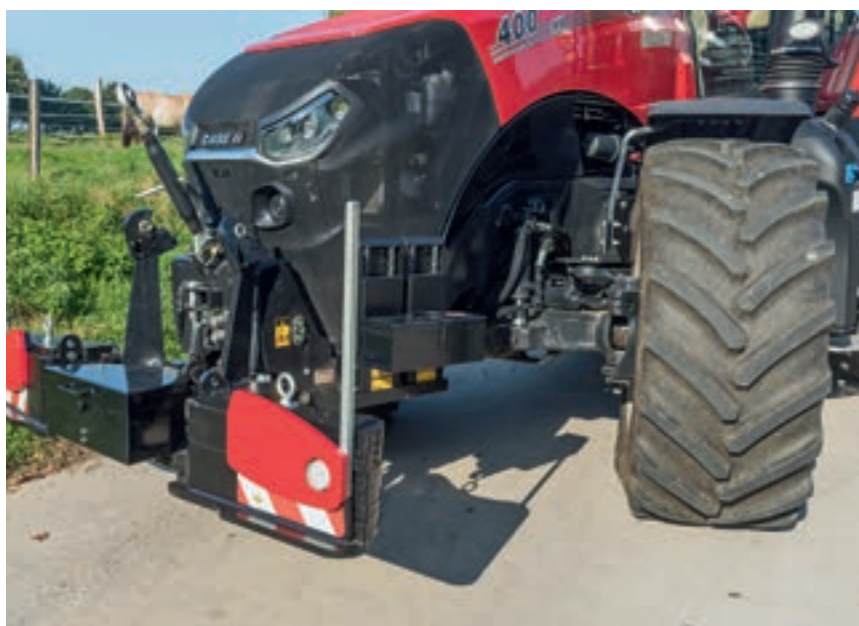
Τα έρματα 900 κιλών και η εργαλειοθήκη (από την Agribumper) τοποθετούνται κοντά στο τρακτέρ και κρατούν τους βραχίονες ελεύθερους. Αλλά η αφαίρεσή τους είναι λίγο αγγαρεία, επομένως δε γίνεται πάντα αυτό.
