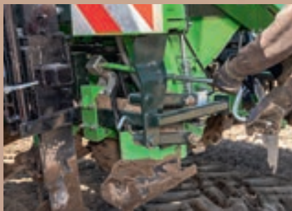
Η μανιβέλα χρησιμοποιείται για τη ρύθμιση του βάθους φύτευσης του Ceres. Το σύστημα είναι αρκετά απλό, αλλά στο μηχάνημα της δοκιμής μας η κλίμακα βάθους δεν φαινόταν εύκολα.
