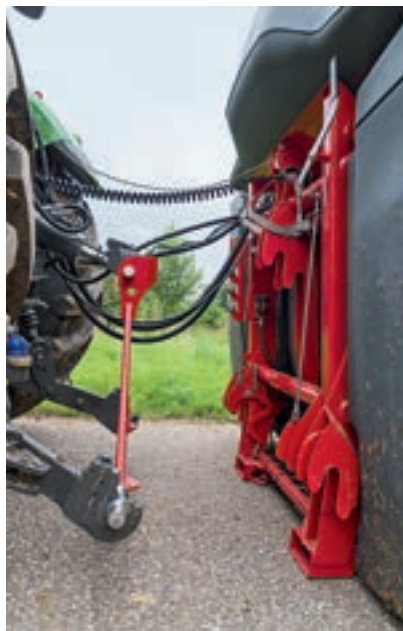
Χάρη στην πλήρως υδραυλική κίνηση και το ελαφρύ πλαίσιο A, η τοποθέτηση είναι εύκολη.
