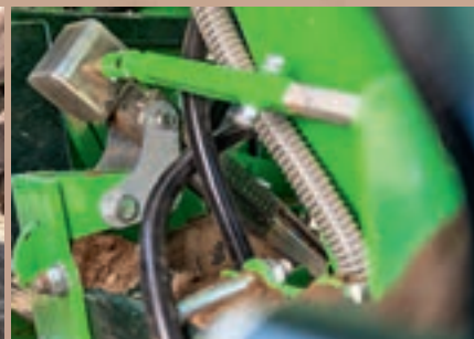
Η μανιβέλα χρησιμοποιείται για τη ρύθμιση του βάθους φύτευσης του Ceres. Το σύστημα είναι αρκετά απλό, αλλά στο μηχάνημα της δοκιμής μας η κλίμακα βάθους δεν φαινόταν εύκολα.
