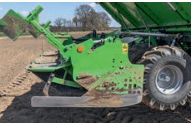
Η πλαινίη πλάκα φαίνεται ευαίσθητη στη φθορά και το κενό ανάμεσα σε αυτήν και τον σκελετό αφήνει το χώμα να συσσωρεύεται.
