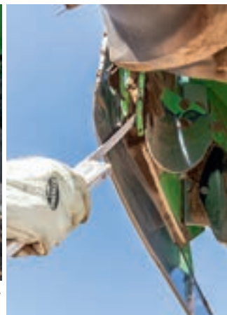
Η πλαινίη πλάκα φαίνεται ευαίσθητη στη φθορά και το κενό ανάμεσα σε αυτήν και τον σκελετό αφήνει το χώμα να συσσωρεύεται.
