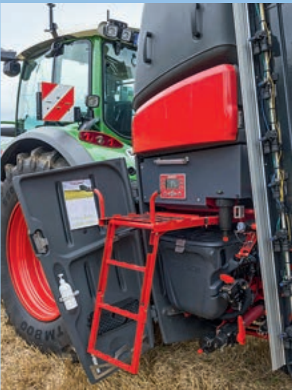
Εκτός από την επαγωγική χοάνη και το θερματικό λειτουργίας, στην αριστερή πλευρά οι χειριστές θα βρουν και μια σκάλα.
