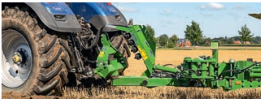
Η κεφαλή τοποθετείται σε έναν περιστρεφόμενο μηχανισμό. Τρία από τα τέσσερα αμορτισέρ προστατεύουν τον ενισχυτή πρόσφυσης, ενώ το άλλο είναι για την απόσβεση του τροχού όταν το άροτρο μεταφέρεται.
