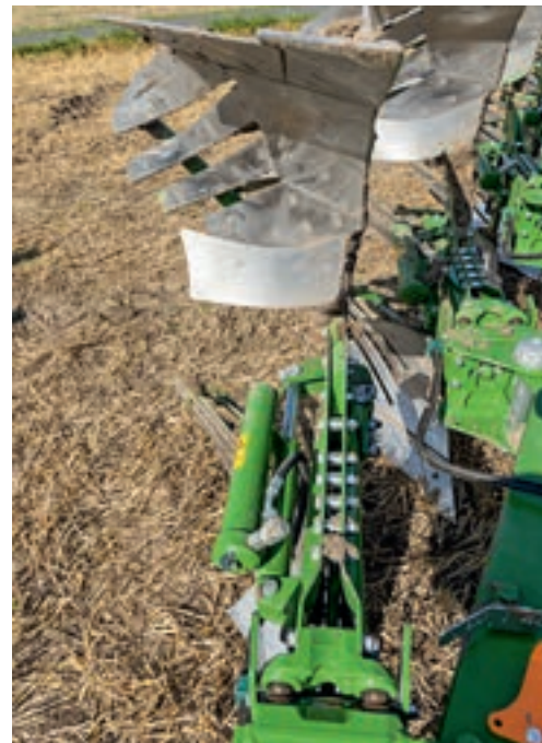
Το σύστημα αυτόματης επαναφοράς μπορεί να ρυθμιστεί κεντρικά ή μεμονωμένα ανά σώμα.
