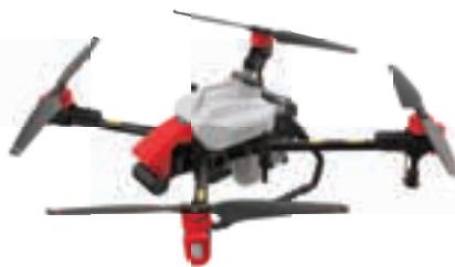
Η αρχιτεκτονική με 4 έλικες επιτρέπει μεγαλύτερη διείσδυση του ψεκαστικού.
