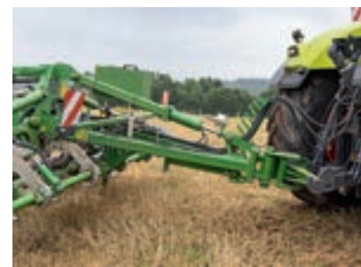
Το υδραυλικό έμβολο στη ράβδο έλξης ανυψώνει τον καλλιεργητή στο κεφαλάρι.
