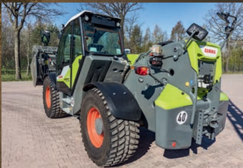
Η σχετικά ψηλή θέση καθίσματος σε συνδυασμό με τη χαμηλά τοποθετημένη μπουύμα παρέχει καλή ορατότητα.
