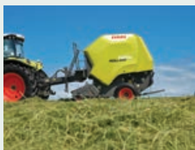
Η Rollant 520RC διαθέτει σταθερό θάλαμο για μπάλες διαστάσεων 1,20X1,25μ..
