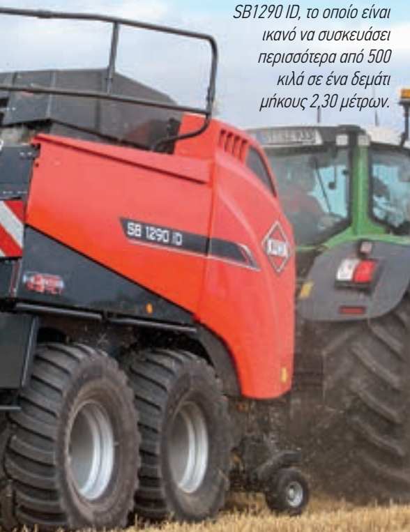
Το πικ απ είναι πλέον 13 εκ. φαρδύτερο και διαθέτει έναν κύλινδρο διαμέτρου 250 χλστ.
