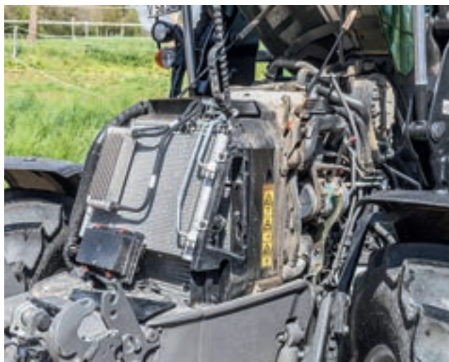
Ο τετρακύλινδρος κινητήρας AGCO Power 4,4 λίτρων προσφέρει καλές επιδόσεις, ενώ κατά τη λειτουργία του έχει μια λογική κατανάλωση καυσίμου.
