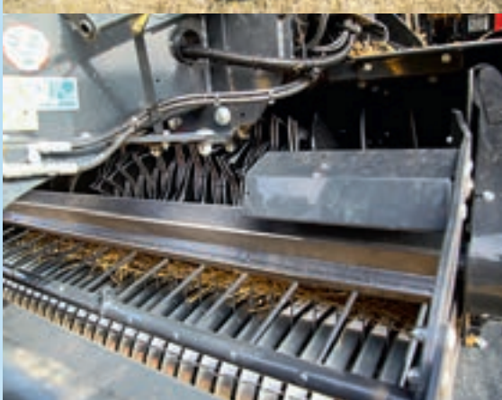
Το πικ απ είναι πλέον 13 εκ. φαρδύτερο και διαθέτει έναν κύλινδρο διαμέτρου 250 χλστ.
