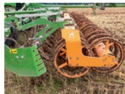
Στο πίσω μέρος μπορεί να επιλεγεί κυλινδρος ή σβάρνα, ανάλογα με τις συνθήκες του εδάφους.
