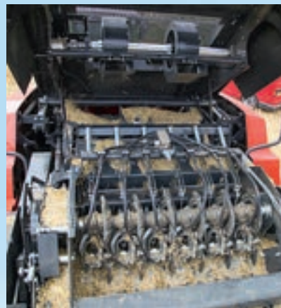
Οι έξι διπλοί κόμποι παράγουν σύντομες κοπές, αλλά οι ισχυροί ανεμιστήρες διατηρούν την περιοχή καθαρή.
