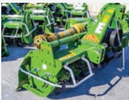
Η φρέζα E στις εγκαταστάσεις της Agrotech. για πλάτη κοπής 1,30 έως 2,55 μέτρα.
