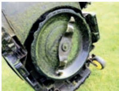
Η Deere χρησιμοποιεί μια παραδοσιακή αναστρέψιμη λεπίδα με εύρος κοπής 31εκ.
