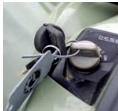
Η Can-Am προσφέρει στα ATV της δύο επιλογές-πρακτικά δύο κλειδιά- λειτουργίας του κινητήρα, με τη μία να επιτρέπει τις πλήρεις δυνατότητες σε θέμα επιδόσεων.
