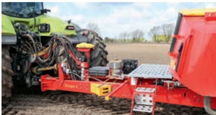
Το κίτρινο εξάρτημα που βρίσκεται επάνω στη ράβδο έλξης είναι εκεί για την επικοινωνία μεταξύ του τάμπλετ, του εξωτερικού ISObus και των δίσκων.
