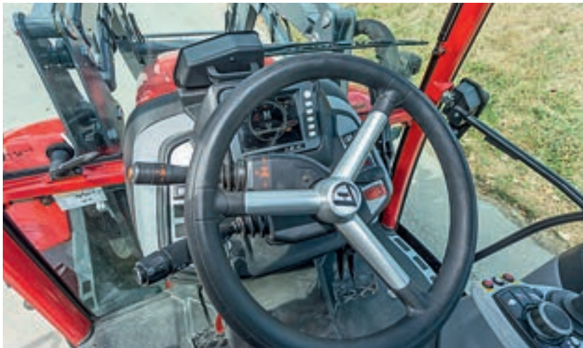
Αλλαγές ταχυτήτων και ενδείξεις στην αριστερή πλευρά της κολόνας του τιμονιού (εικόνα δεξιά). Τα γράμματα στην οθόνη είναι πολύ μικρά (πάνω).
