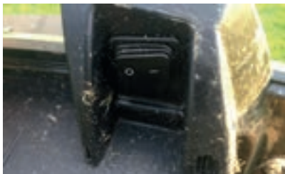
Υπάρχει ένας βασικός διακόπτης κάτω από το κερούλι για τη λειτουργία της μηχανής.
