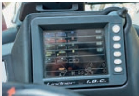
Αλλαγές ταχυτήτων και ενδείξεις στην αριστερή πλευρά της κολόνας του τιμονιού (εικόνα δεξιά). Τα γράμματα στην οθόνη είναι πολύ μικρά (πάνω).
