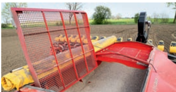
Η χοάνη λιπάσματος ανασπώνεται από εκεί που βρίσκεται και χρησιμοποιεί δύο αναδευτήρες σε κάθε πλευρά.
