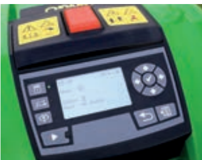
Όλες οι ρυθμίσεις γίνονται με τη χρήση κουμπιών σε καθεμιά από τις δύο πλευρές της κεντρικής οθόνης, η οποία φωτίζεται από το πίσω μέρος. Η δομή του μενού είναι σχετικά απλή.
