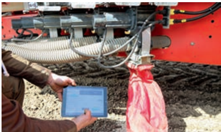
Η σύνδεση σε Wi-fi επιτρέπει στον χειριστή να κάνει μέσω iPad την βαθμονόμηση και ελέγχει τη σπορά.
