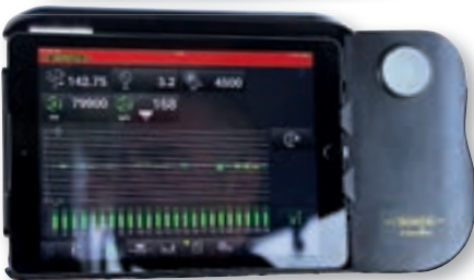
Ενώ η σπαρτική είναι συμβατή και μπορεί να ελεγχθεί μέσω iPad, χρειάζεται τεμαχικό ISObus (όπως το S10 της Claas) για να γίνουν οι χειρισμοί.
