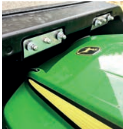
Οι δύο μεταλλικές πλάκες εφάπτονται με τα σημεία φόρτισης στη μηχανή κουρέματος.
