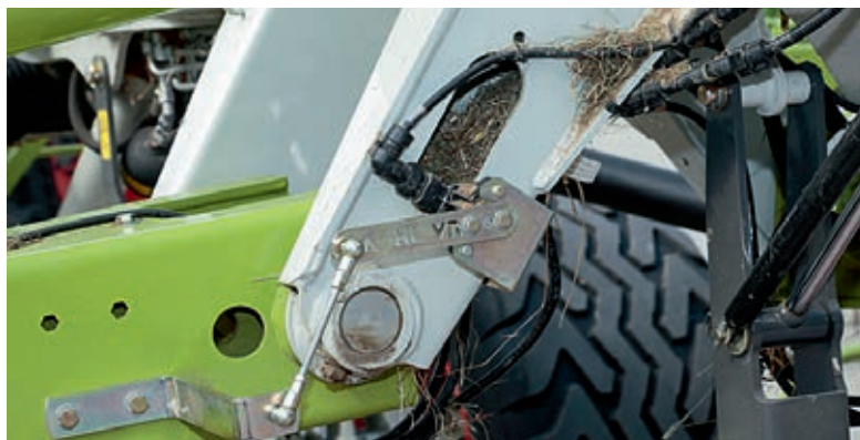
Αυτός ο χορτοσυλλέκτης έχει πολλούς αισθητήρες και καλώδια. Παρόλο που όλα αυτά κάνουν τα πράγματα πιο περίπλοκα, δεν αντιμετωπίζαμε πρόβλημα με τα ηλεκτρονικά συστήματα.
