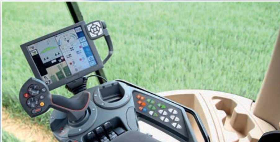
Το νέο μπράτσο καθίσματος και η οθόνη προήλθαν από το μηχανήμα χορτονομής Katana.
