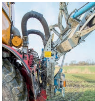
Ο σύνδεσμος Cat IV τριών σημείων μπορεί να χειρίζεται μέχρι 10 τόνους.
