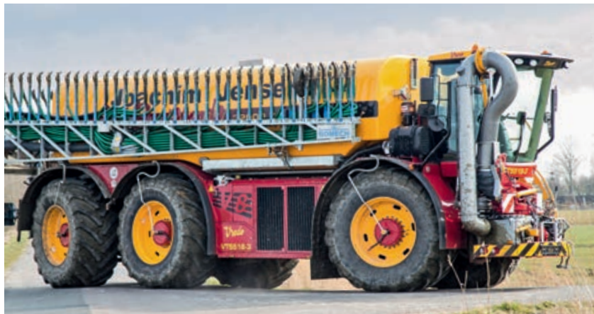
Το VT 6018-3 έχει κίνηση στους τέσσερις τροχούς, που είναι απαραίτητη για τους ελιγμούς.
