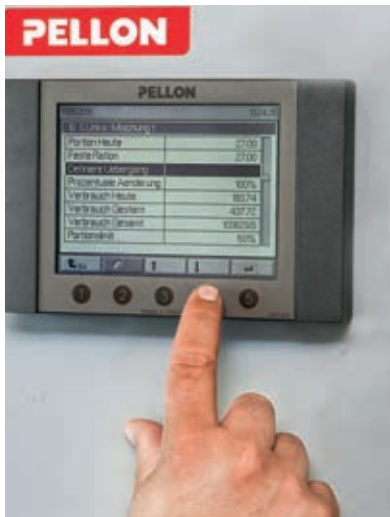
Οι ποσότητες τροφής, τα διαστήματα σίτισης και οι ομάδες σίτισης μπορούν να προγραμματίζονται στην οθόνη του σταθμού σίτισης.
