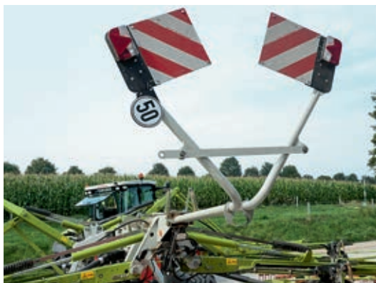
Οι πλάκες φωτισμού διπλώνουν, ώστε να μειώνεται το πλάτος του μηχανήματος, πράγμα πολύ χρήσιμο για τις στροφές.
