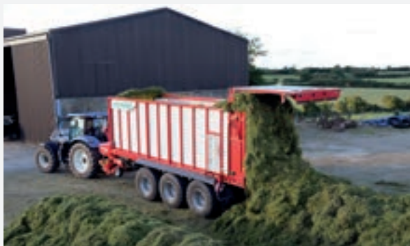
Το Jumbo άδειαζε γρήγορα, καθώς βοηθά το διπλό υδραυλικό μοτέρ και οι έξι αλυσίδες δαπέδου.
