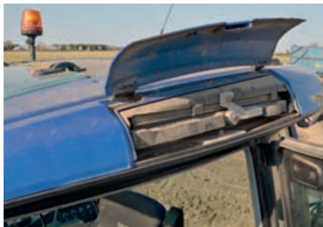
Το κάλυμμα του φίλτρου καμπίνας κινδύνευε να πεταχτεί με τον δυνατό αέρα και αντικαταστάθηκε με ένα πιο σγκώδες εξάρτημα που καλύπτεται με εγγύηση.
