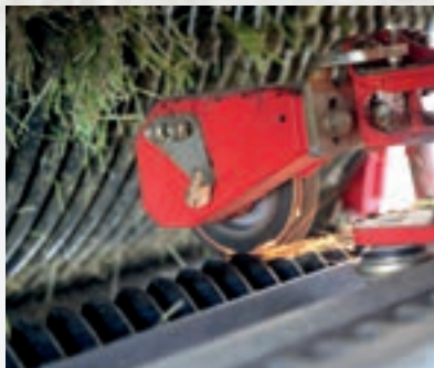
Ένας από τους δίσκους ακονίσματος κινείται μαζί με τα μαχαίρια, ανανεώνοντας την ακμή.
