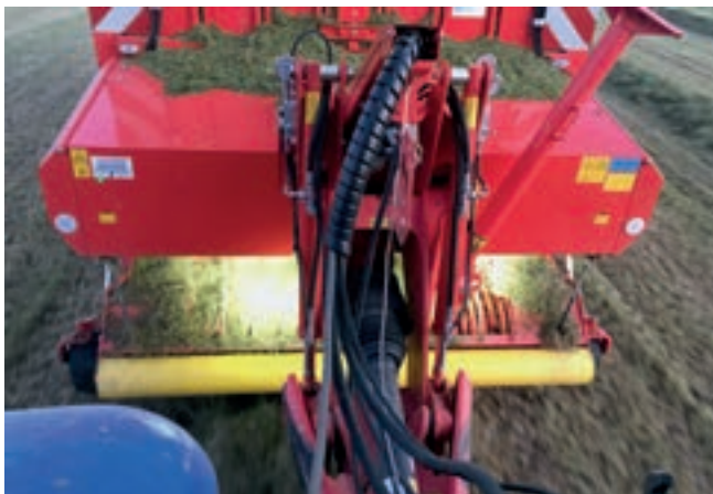
Τα φώτα πίσω από τη ράβδο έλξης κάνουν εξαιρετική δουλειά για τον φωτισμό του τυμπάνου, σε σημείο που δεν χρειάζονται τα πίσω φώτα του τρακτέρ.
