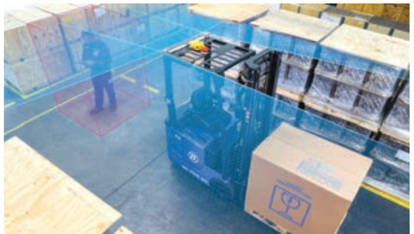
Ένα πλήρως αυτοματοποιημένο, ηλεκτρικό και δικτυωμένο περνοφόρο παρουσίασε η ZF στο Hannover Fair. Εξοπλισμένο με κάμερα και ραντάρ μπορεί να λύσει τα χέρια σε κάθε εγκατάσταση logistics.
