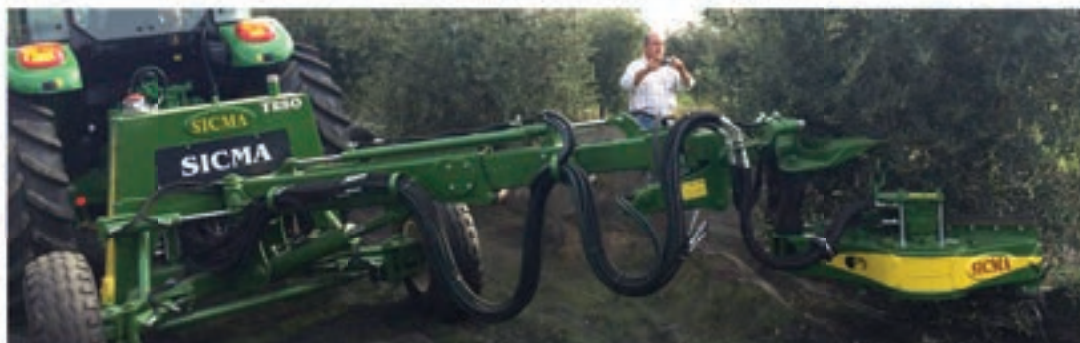
ΠΑΡΕΛΚΟΜΕΝΟΣ ΔΟΝΗΤΗΣ ΤΡ80 ΜΕ ΟΜΠΡΕΛΑ Η΄ ΧΩΡΙΣ (ΠΡΟΣΑΡΜΟΖΕΤΑΙ ΣΤΟ ΠΙΣΩ ΜΕΡΟΣ ΤΟΥ ΤΡΑΚΤΕΡ)
