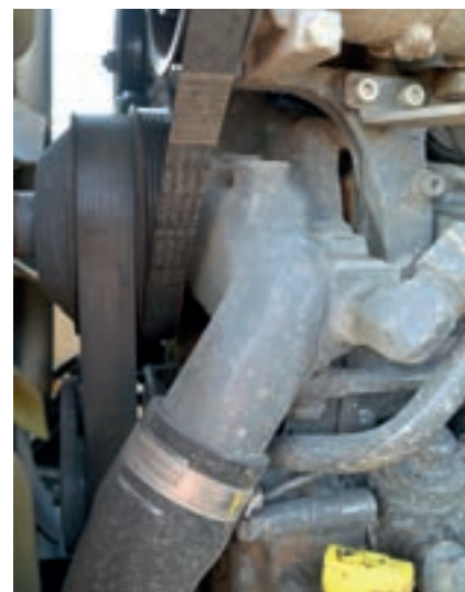
Ένα συνθησιμένο πρόβλημα με τους εξακύλινδρους Sisu είναι ότι η αντλία νερού παρουσιάζει υπερβολικό τζόγο στον άξονα όταν συμπληρώσει 2.000 ώρες.
