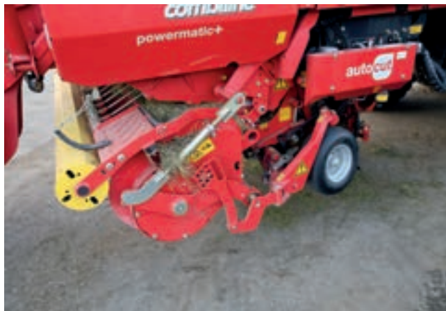
Στο πιο φαρδύ συλλεκτικό τύμπανο, οι τροχοί μέτρησης βάθους περιστρέφονται υδραυλικά προς τα πίσω συμβάλλοντας στη μείωση του πλάτους για το δρόμο.
