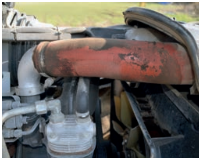
Η αντικατάσταση του εύκαμπτου σωλήνα στροβιλοσυμπεστή χρειάστηκε να γίνει στις 1.361 ώρες.
