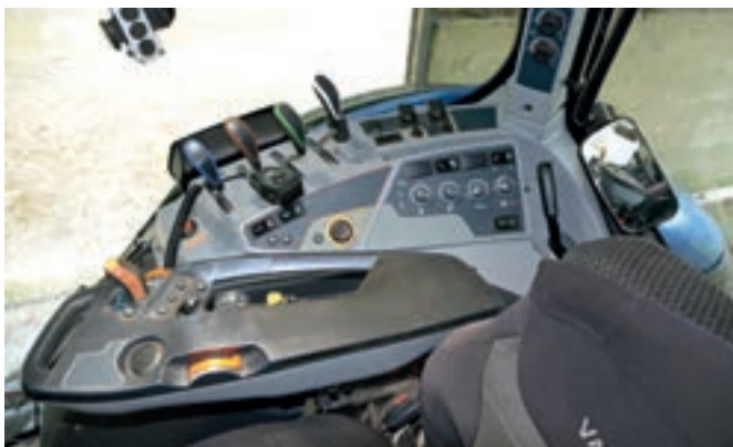
Το τρακτέρ «Active» της δοκιμής μας διαθέτει το κιβώτιο Powershift 30F x 30R της Valtra και υδραυλικό σύστημα με παροχή 160 λίτρα/λεπτό και αίσθηση φορτίου. Τα πράγματα διατηρούνται απλά με τις μηχανικές βαλβίδες πνιού και το ότι δεν υπάρχει οθόνη ελέγχου στο μπράτσο καθίσματος.
