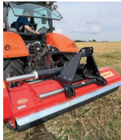
Το πλάτος εργασίας είναι 2,8 μέτρα, αλλά το συνολικό πλάτος μεταφοράς είναι 3 μέτρα.
