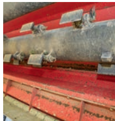
Οι λεπίδες είναι σε ευθείες σειρές. Το συγκριμένο μηχάνημα είχε εκείνες με το πλάτος των 115 χλστ.
