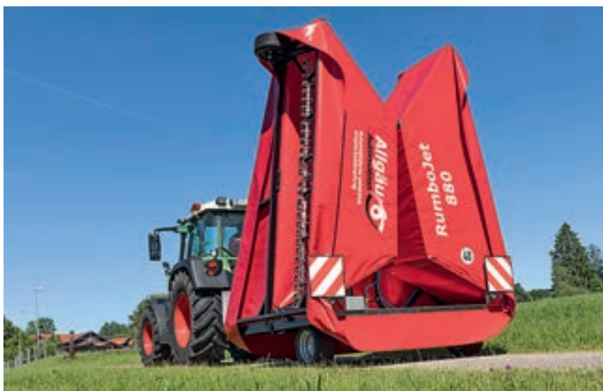
Το δίπλωμα μέσω υδραυλικού συστήματος παρέχει πλάτος κατά την κίνηση στο δρόμο έως 2,97 μ..
