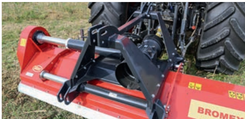
Το στιβαρό συρόμενο πλαίσιο μετατοπίζει τον καταστροφέα κατά 500 χιλιοστά πλευρικά, ενώ το κιβώτιο ταχυτήτων διαθέτει συμπλέκτη ολίσθησης υπέρβασης.
