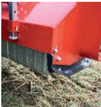
Οι χαλύβδινες πλάκες διατηρούν το υλικό μέσα στο μηχάνημα. Τα μαύρα στηρίγματα αντικαθίστανται.
