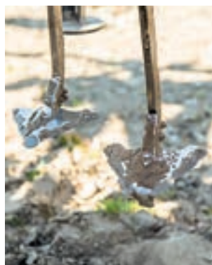
Ο μύτες των πιο ανθεκτικών δοντιών δεν τα πάνε καλά με τις πέτρες.
