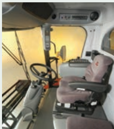
Μέσα στην καμπίνα, θα βρουν οι χειριστές, το τερματικό αφής TechTouch.
