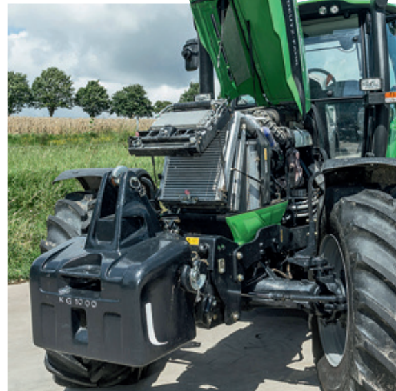
Ο εξακύλινδρος κινητήρας Deutz 210 ίππων εξακολουθεί να είναι συμβατός με Stage IIIB.
