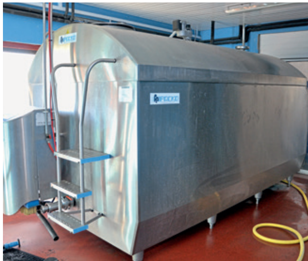
Η νέα δεξαμενή γάλακτος Packo Fullwood 6.000 λίτρων εγκαταστάθηκε για να μειωθεί το κόστος μεταφοράς του γάλακτος.
