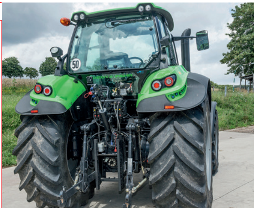
Δεν μπορούμε να κατηγορήσουμε τον πίσω σύνδεσμο που ανυψώνει 7,5 τόνους -είναι κορυφαίο αποτέλεσμα- αλλά η ονομαστική παροχή 113 λίτρων/λεπτό είναι κάπως χαμηλή.
