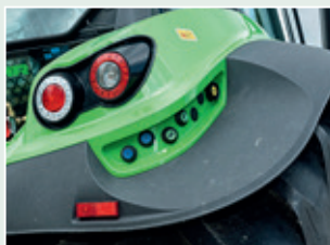
Εξωτερικές ρυθμίσεις για το σύνδεσμο, τις βαλβίδες και το ρτο.
