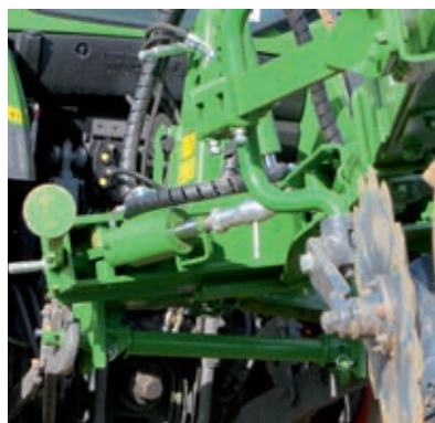
Το πλάτος αυλακωτήρα ρυθμίζεται με μη αυτόματο τρόπο στο Amazone Cayros
