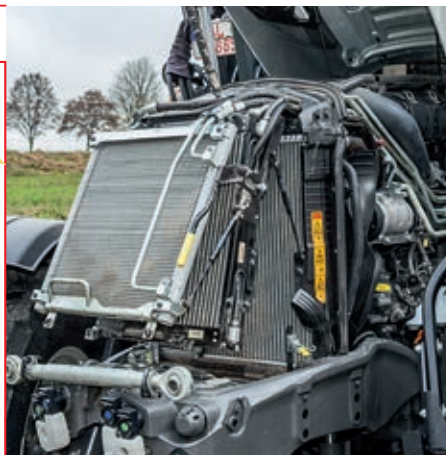
Ο κινητήρας AGCO Power 4,9 λίτρων είναι συμβατός με Stage IV και έχει ικανοποιητικά χαρακτηριστικά ισχύος.
