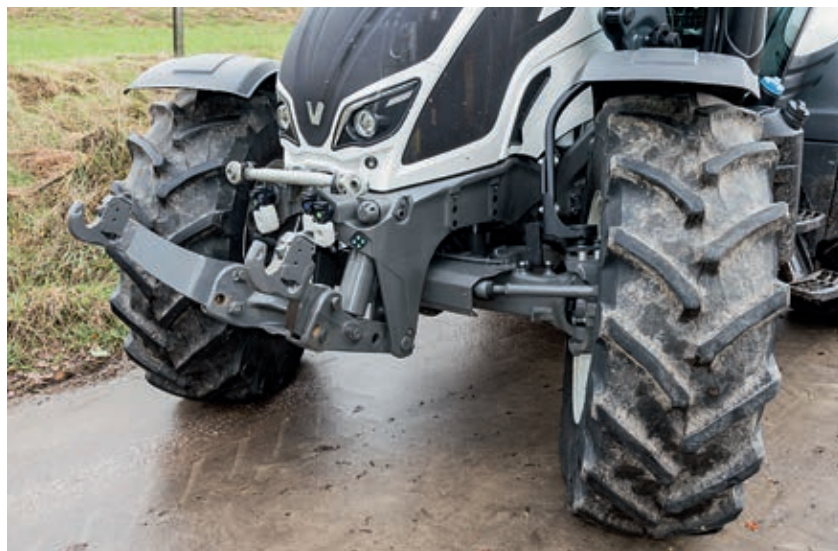
Ο μπροστινός άξονας με ανάρτηση θυμίζει τη διάταξη των Fendt 500 και παρέχει εξαιρετική άνεση και κλειστό κύκλο 10,40 μ. Το σήμα του μοντέλου είναι πολύ μικρό και βρίσκεται κοντά στα φώτα.
