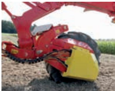
Με ισχύ 60 kW, το ηλεκτρικό eTrac μοτέρ κρύβεται στον τροχό άρσης.
