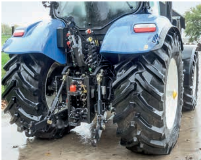
Η ισχύς ανύψωσης και το ύψος είναι οριακά αποτελέσματα για ένα τρακτέρ αυτού του μεγέθους. Οι βραχίονες θα έπρεπε να προσφέρουν ρύθμιση Cat III.
