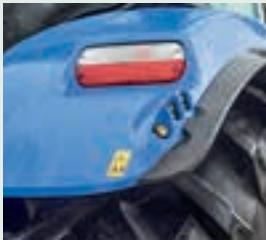
Τα χειριστήρια συνδέσμου, υδραυλικού συστήματος και pto υπάρχουν και στις δύο πλευρές.
