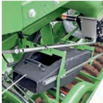
Το Smart Center φιλοξενεί τα στοιχεία και τα χειριστήρια ελέγχου βαθμονόμησης.
