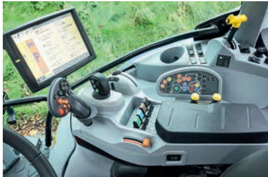
Το νέο σύστημα μετάδοσης κίνησης Dynamic Command ελέγχεται με ένα κουμπί. Ο τροχός δεν έκανε τίποτα στο μοντέλο προ-παραγωγής αλλά θα χρησιμοποιηθεί για το προαιρετικό GSM II και τη μείωση του γκαζιού.
