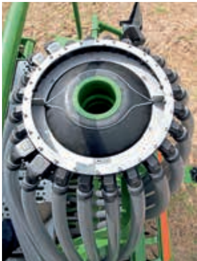
Η τμηματοποιημένη κεφαλή διανομής διαθέτει σύστημα αποκλεισμού στο μισό πλάτος.
