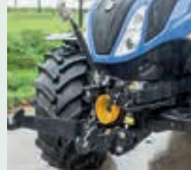
Υπάρχει άγκιστρο Cat II στον μπροστινό σύνδεσμο και δεν έχει πρακτική βάση επάνω συνδέσμου.
