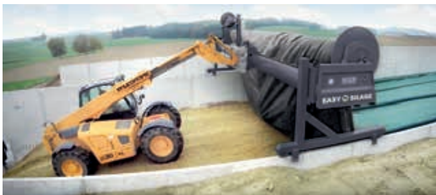
Σε μια τρίτη εκδοχή του Easy Silage, το καρούλι μετακινείται με την βοήθεια τρακτέρ, ή φορτωτή.
