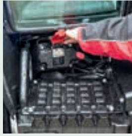
Ο θετικός ακροδέκτης μπαταρίας βρίσκεται σε εξαιρετική θέση για την άμεση εκκίνηση.
