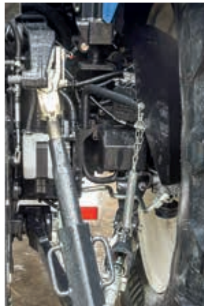
Δεν μας ενθουσίασαν οι σταθεροποιητές με τις δύσχρηστες προαιρετικές αλυσίδες.
