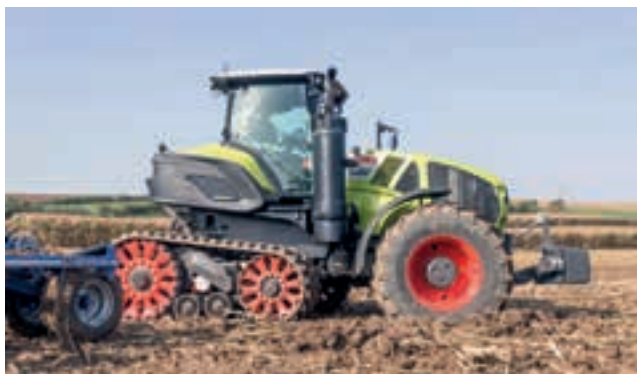
Ο εξοπλισμός κίνησης TerraTrac στο Axion 960 είναι το καινούργιο όπλο της Claas για την ενίσχυση της αποτελεσματικότητας της πρόσφυσης.
