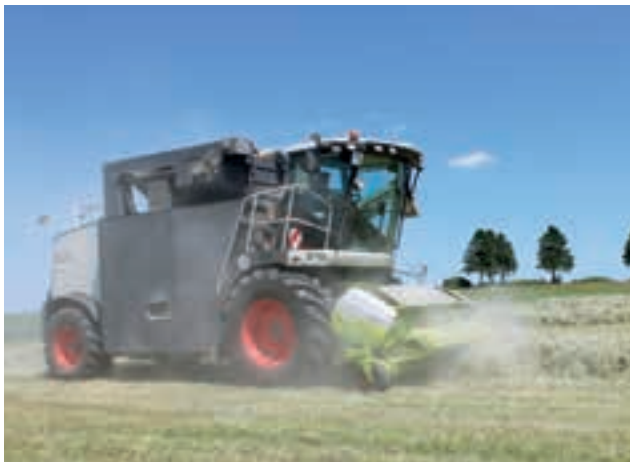
Ικανό να πελετοποιεί έναν μεγάλο αριθμό καλλιιεργειών, το Metitron 560 στηρίζεται στην αυτοκινούμενη θεριζοαλωνιστική Claas Jaguar 960.
