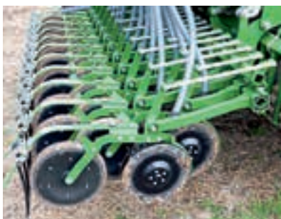
Υπάρχει επιλογή ανάμεσα στον διπλό δίσκο Twin-Tec ή τα υνιά RoTec Pro με μονό δίσκο.
