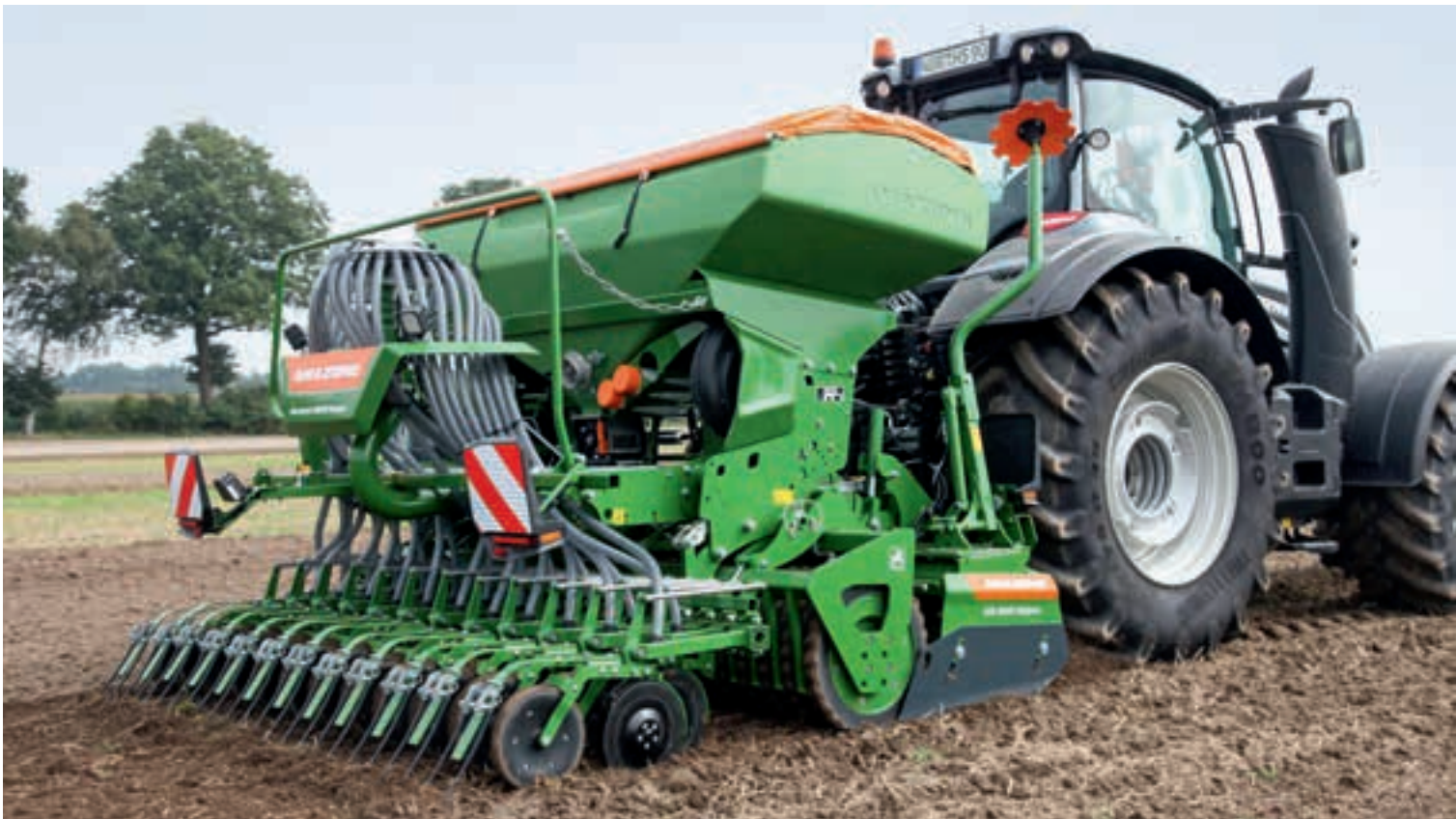
Στο Amazone Centaya 3000 Super η κεφαλή διανομής βρίσκεται πίσω από την πλαστική χοάνη.
