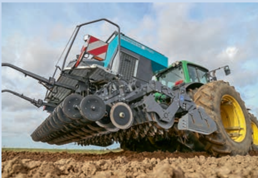
Το μηχάνημα της δοκιμής ήταν εξοπλισμένο με τη μονάδα μαχαiriών διπλού δίσκου Twindisc με πίεση έως 50 κιλά. Η πίεση ρυθμίζεται χειροκίνητα σε κάθε μαχαίρι..
