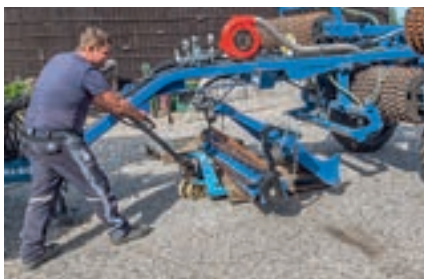
Ξεβιδώστε οκτώ βίδες για να αποδεσμεύσετε κάθε ομάδα εμπρόσθιων εργαλείων.
