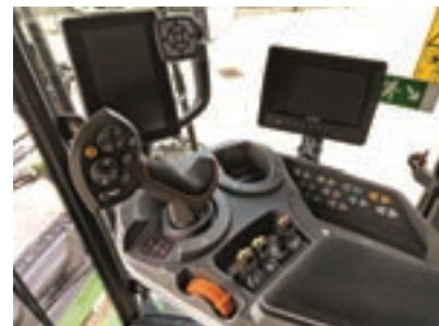
Το joystick πολλαπλών λειτουργιών βρίσκεται στο μπροστινό τμήμα του υποβραχιονίου Variotronic.
