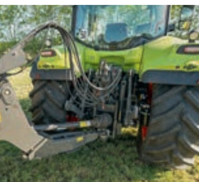
Η ράβδος έλξης είναι λεπτή και οι εύκαμπτοι σωλήνες είναι τακτοποιημένοι.
