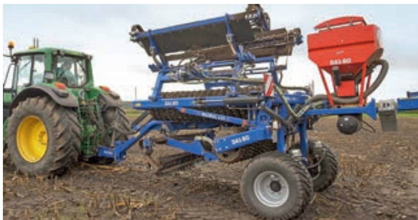
Διπλώνει και γίνεται ένα μηχανήμα μικρών διαστάσεων που μπορεί να κινηθεί στον δρόμο. Με γεμάτη χοάνη, το μηχανήμα ζυγίζει περίπου 6 τόνους.
