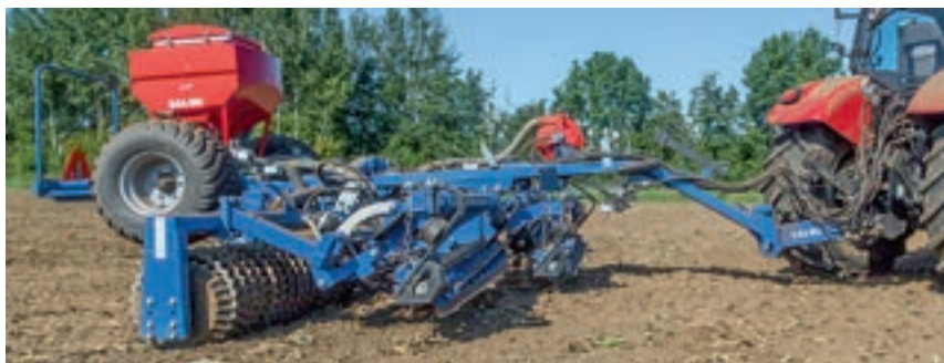
Το Maxiroll τοποθετείται στη ράβδο έλξης και η μονάδα της δοκιμής μας είχε κοτσαστόρο K80. Το στήριγμα εύκαμπτων σωλήνων για τους οκτώ σωλήνες χρειάζεται βελτίωση.
