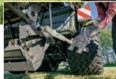
Μία λαβή χρησιμοποιείται για το ξεκλείδωμα των λεπίδων στην τράπεζα μαχαιριών
