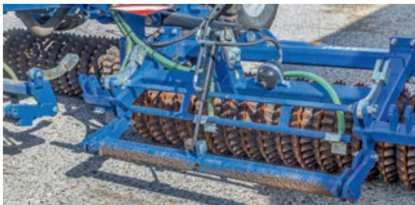
Τα ακροφύσια εγχυτήρα απλώνουν τους σπόρους μπροστά από τον κύλινδρο Cross-Combi των 500 χιλιοστών/550 χιλιοστών. Τα εμπρόσθια εργαλεία μπορούν να πιεστούν προς τα κάτω με τα έμβολα.
