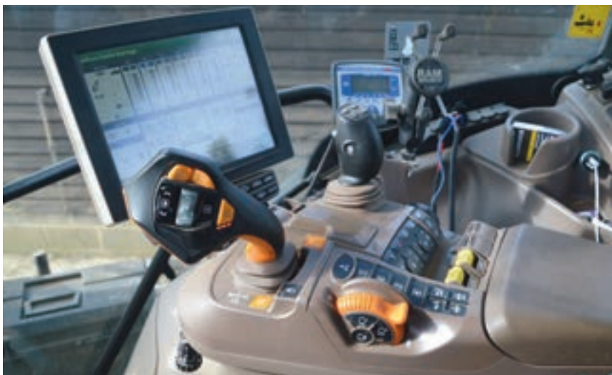
Το υποβραχιόμιο με τις ομαδοποιημένες λειτουργίες του ελκυστήρα εκτιμήθηκε σημαντικά από τον δοκιμαστή. Το ίδιο ισχύει και για το ξεχωριστό λεβιέ με τα προσαρμοσίμα κουμπιά για μεγαλύτερη άνεση στην εργασία.
