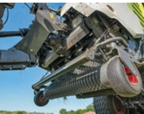
Το πικ απ πλάτους 1,72 μέτρων συλλέγει ακόμη και κοντό γρασίδι χωρίς προβλήματα.
