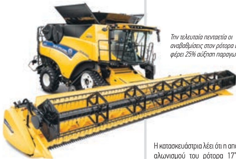
Το αναβατήριο καρπού στο 14.500 λίτρων σιλό αυξάνει κατά 10% τον όγκο μεταφοράς καρπού.
