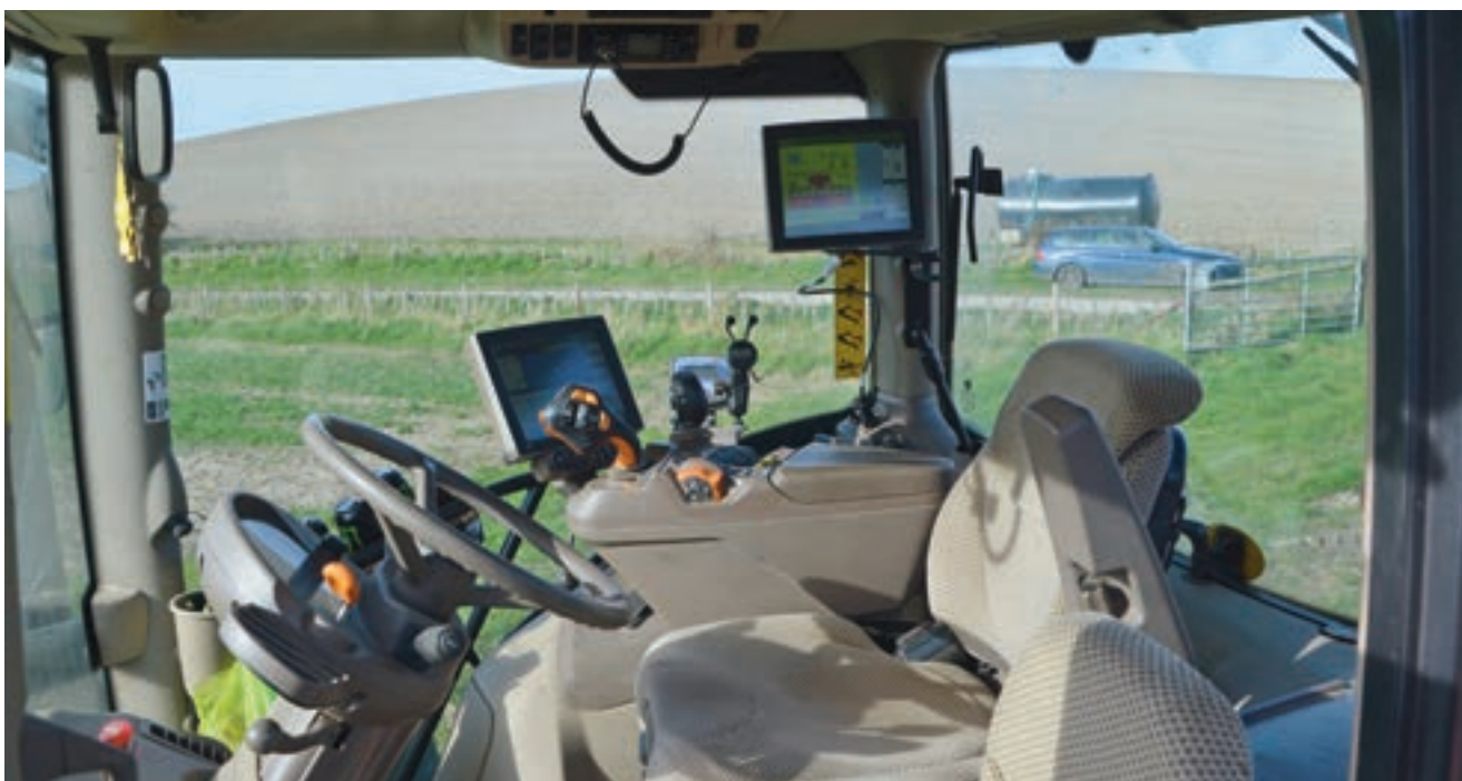
Πέρα από το τρίξιμο στο παράθυρο η καμπίνα είναι πολύ ποιοτική και ευρύχωρη. Στην βασική οθόνη 4200 προστέθηκε μια δεύτερη για να λειτουργεί ως αυτόνομο σύστημα ελέγχου ISObus. Και αποδείχθηκε φθηνότερη και αποτελεσματικότερη επιλογή συγκριτικά με την αγορά ενός εξοπλισμού αποκλειστικά για την σπαρτική Horsch.
