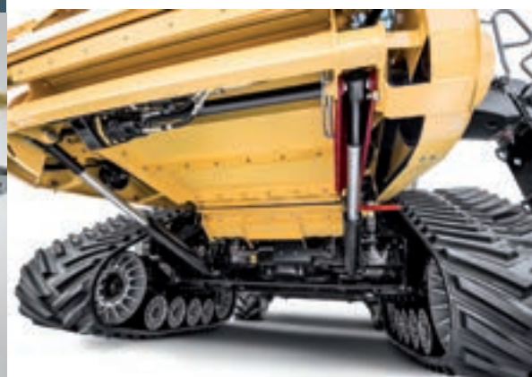
Το αναβατήριο καρπού στο 14.500 λίτρων σιλό αυξάνει κατά 10% τον όγκο μεταφοράς καρπού.
